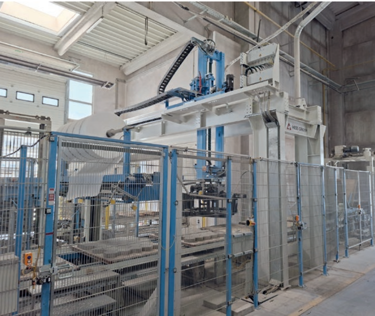
Am Ende der Trockenseite übernimmt der neue Paketierer Servo 700-2 das Transportieren und Stapeln der Lagen auf der Verpackungs- und Abtransportlinie.
