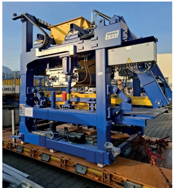
Für den Transport nach Algerien vorbereitet: Vorsatzbetonfüllteil der XL-R 9.1
