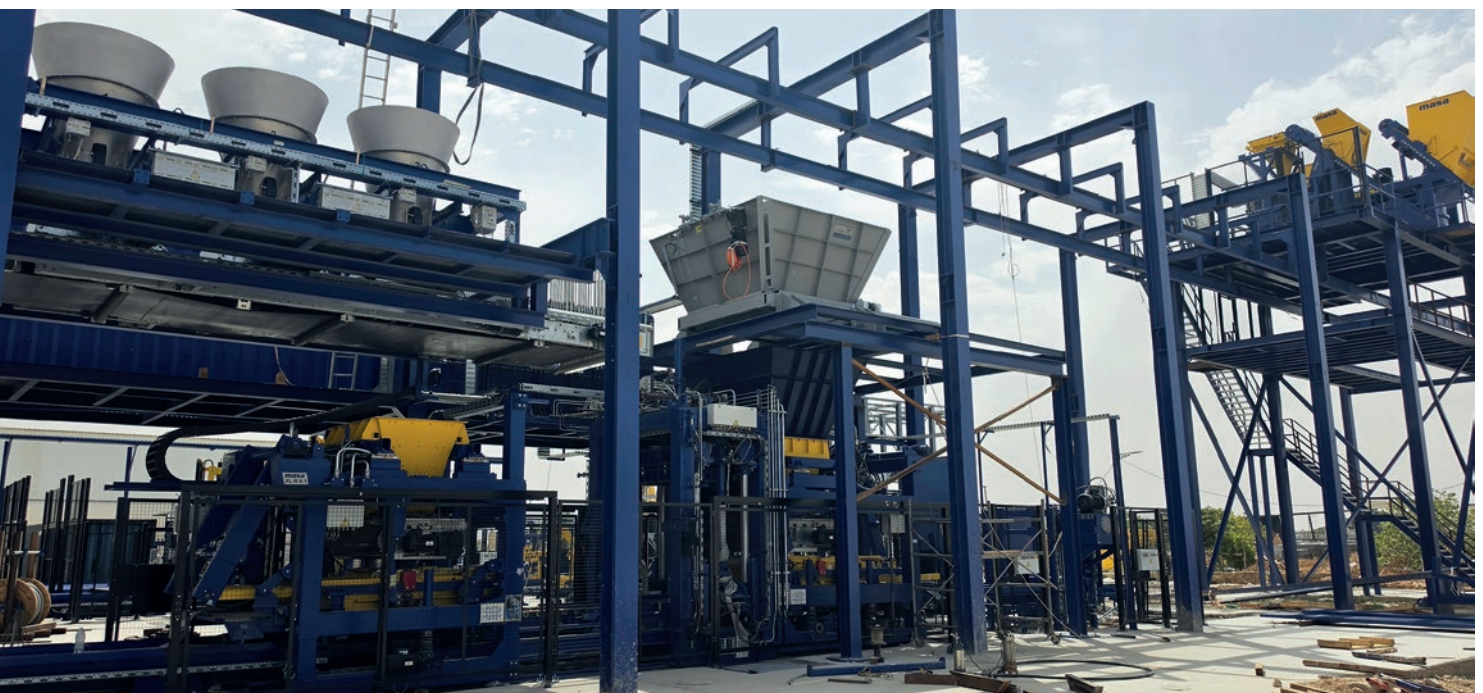
Noch im Aufbau, aber bereits deutlich erkennbar: Die Masa XL-R 9.1 mit installiertem Multi-Color-System bildet das Herzstück der neuen Produktionslinie.
