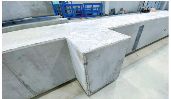
对于 GBS 预制构件的设备来说，即使每边有多个牛腿的柱子也没有问题
