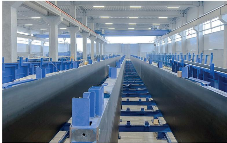
模具提供了高表面质量和快速生产的圆柱预制件
