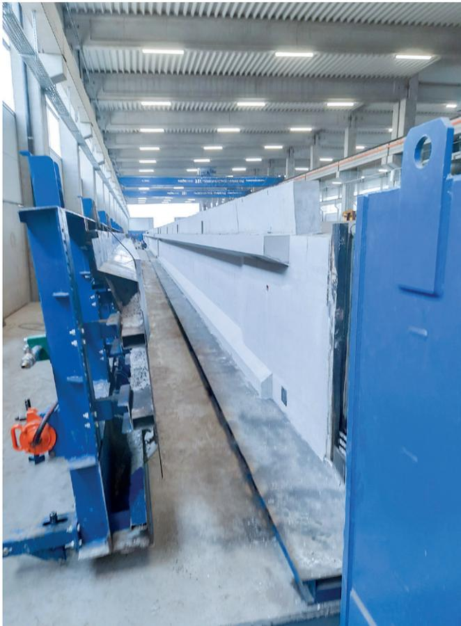
工字梁的可调节模具长度 32 米，可为中大型工业建筑生产高质量的横梁
