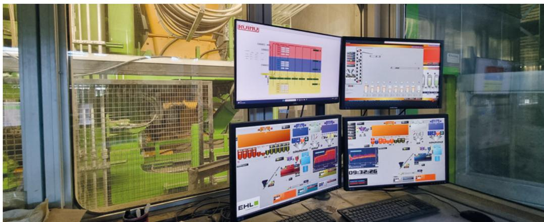
Controllo centralizzato dell'impianto di dosaggio e miscelazione tramite il sistema di controllo del processo Sauter s-mix.
