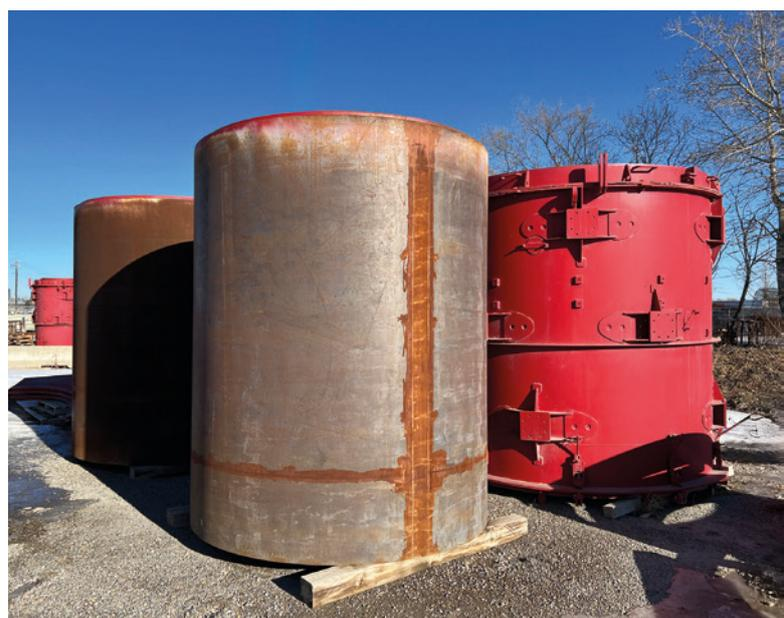
Moules métalliques de différents diamètres pour la production de tuyaux de fonçage
