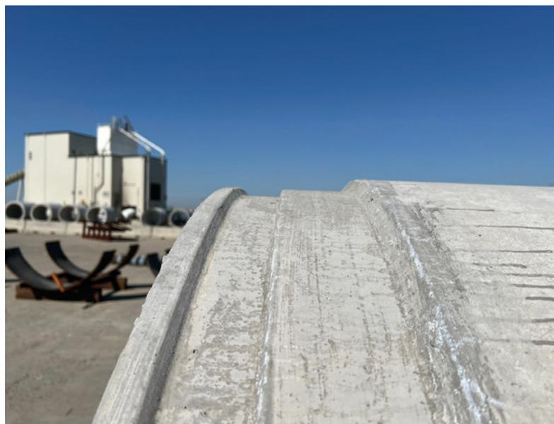
Tuyaux de fonçage avec revêtement intérieur et profilé pour joint torique d'étanchéité
