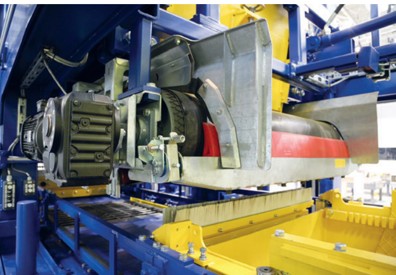
Дозирующие ленты обеспечивают регулируемое и оптимальное заполнение вагонетки для основного и облицовочного бетона
