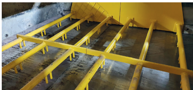
Вибрирующая колосниковая вставка, адаптированная к изделию
