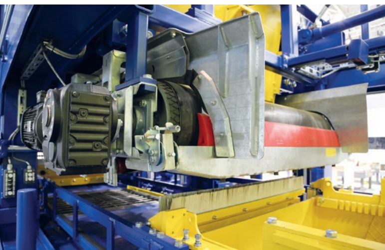
Taśmociągi dozujące umożliwiają elastyczne i zoptymalizowane napełnianie szuflad zasypowych betonu konstrukcyjnego i licowego.
