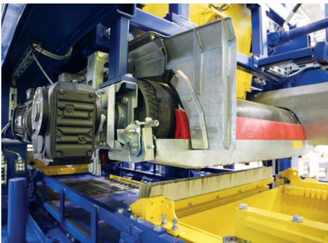
*Las cintas dosificadoras permiten un llenado variable y óptimo del carro de llenado de hormigón monocapa y hormigón bicapa*
