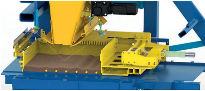
Messung der Betonmenge via Laser
