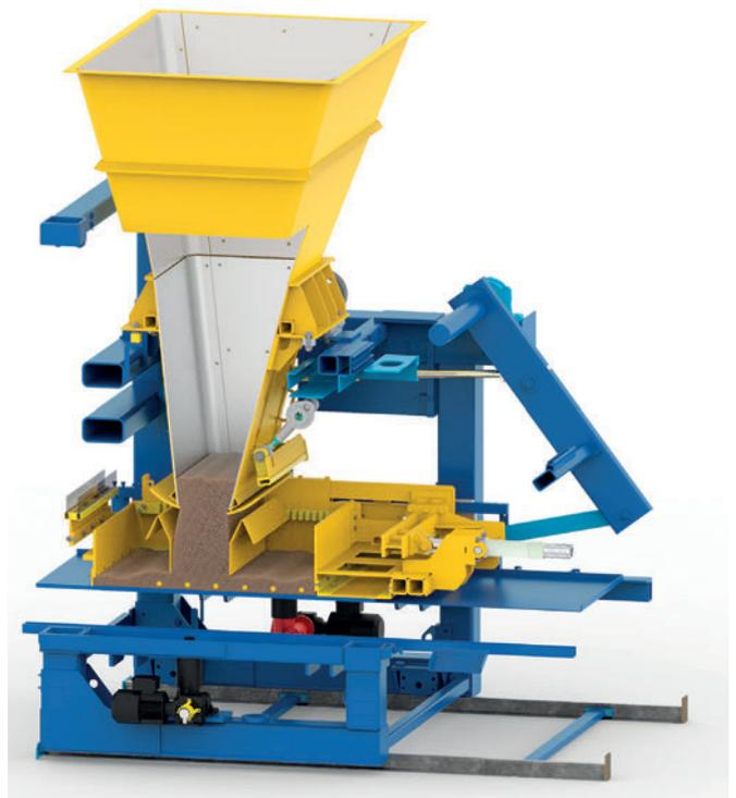
*Anzahl, Länge und Positionierung der Dosierwinkel wirken sich unmittelbar auf den Materialfluss aus und ermöglichen damit eine exakte Dosierung und Wiederholgenauigkeit*
