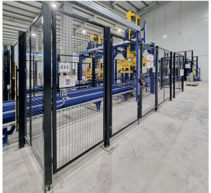
*Los dispositivos de centrado I y II de los dos transportes de retorno que discurren en paralelo preparan los productos curados en la bandeja de producción para su paletizado soltando y centrando la capa de bloques.*
