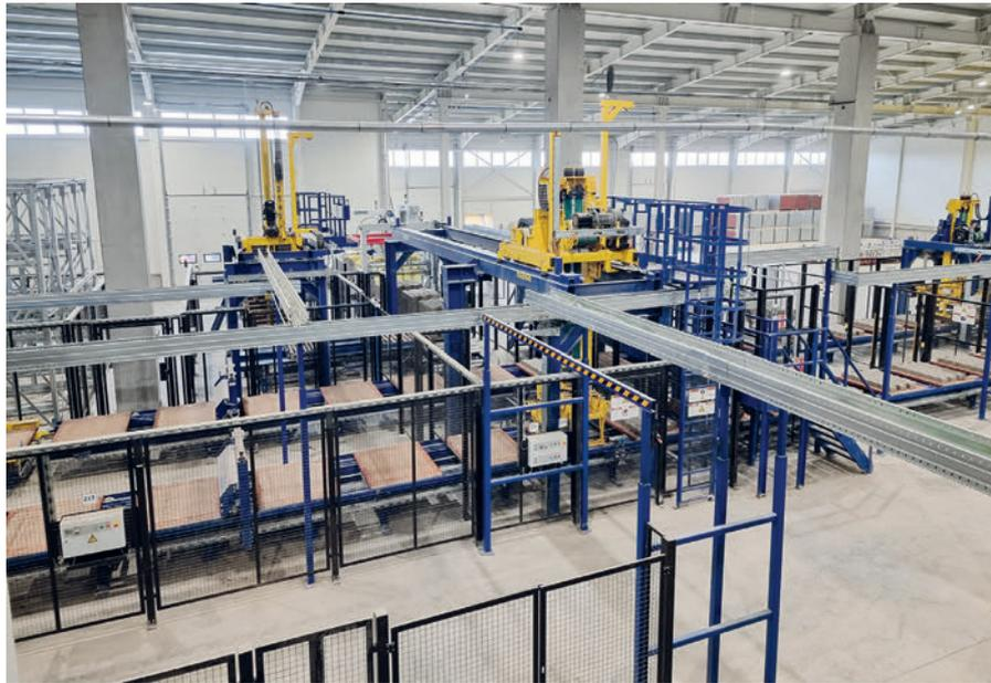
Instalación compleja con tecnología Masa: lado seco con dos transportes de retorno, paletizado, pinza para palets de transporte y sistemas de alimentación para las bandejas de producción vacías. Como proveedor integral, Masa suministra también los canales para cables.
