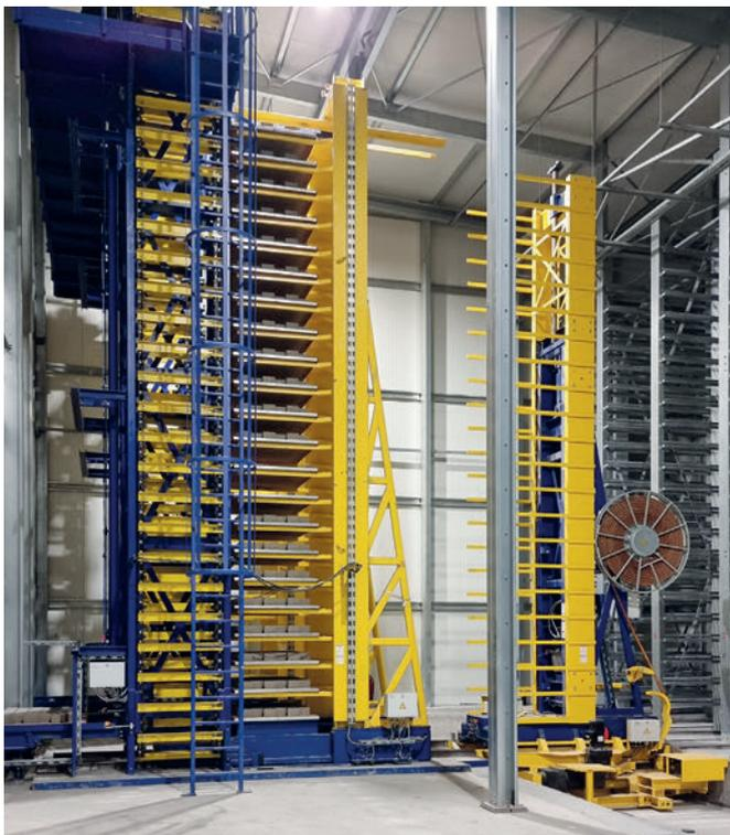
*Para la transferencia de los productos curados de la zona de curado al transporte de retorno, el sistema de control de la instalación de Masa coordina los componentes carro multiforca, carros multiforca intermedios y descensor.*
