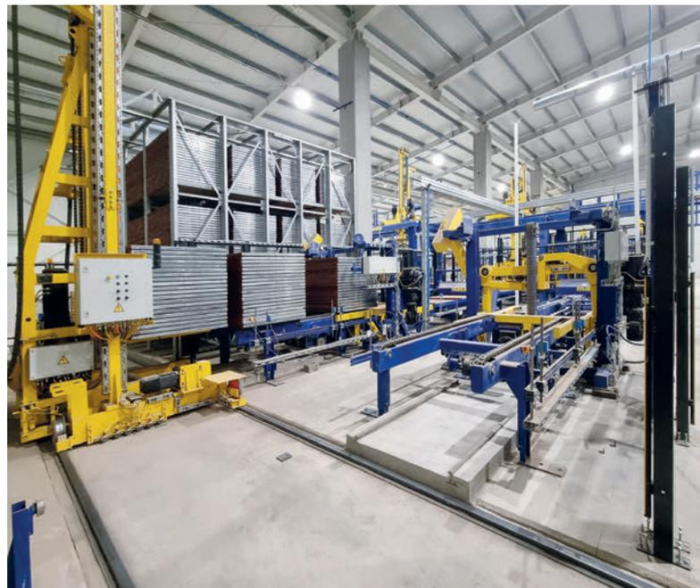
*El carro de transporte de Masa almacena y retira de forma fiable las bandejas de producción vacías de la estantería de almacenamiento.*
