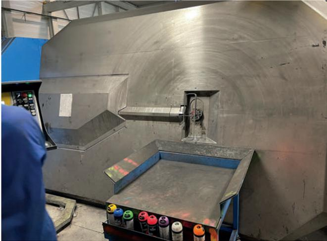
Die Pluristar ist Bügelbiegeautomat, Richtmaschine und Doppelbiegemaschine zugleich.
