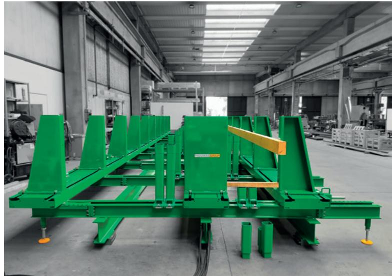
Die Doppelschalungen werden für die Produktion der meistverkauften Produkte – die Stützen – verwendet und sind 14 m lang.
