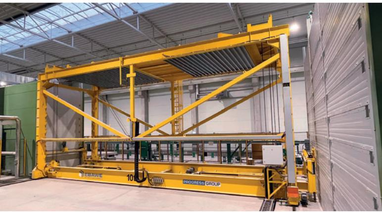
Der Palettenstapler legt die betonierten Elemente in das Aushärteregal.
