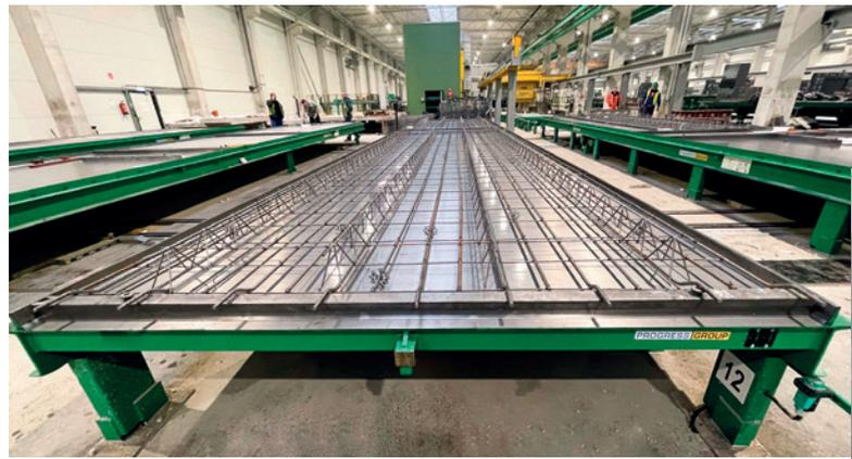
Die Bewehrung für die Elemente wird automatisiert und damit genau wie geplant produziert.
