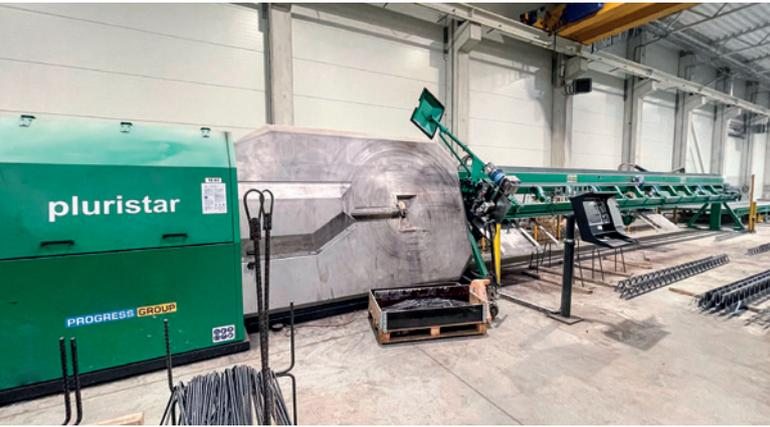
Die Multifunktionsmaschine Pluristar kann den benötigten Bewehrungsstahl direkt vom Coil richten, schneiden und biegen.
