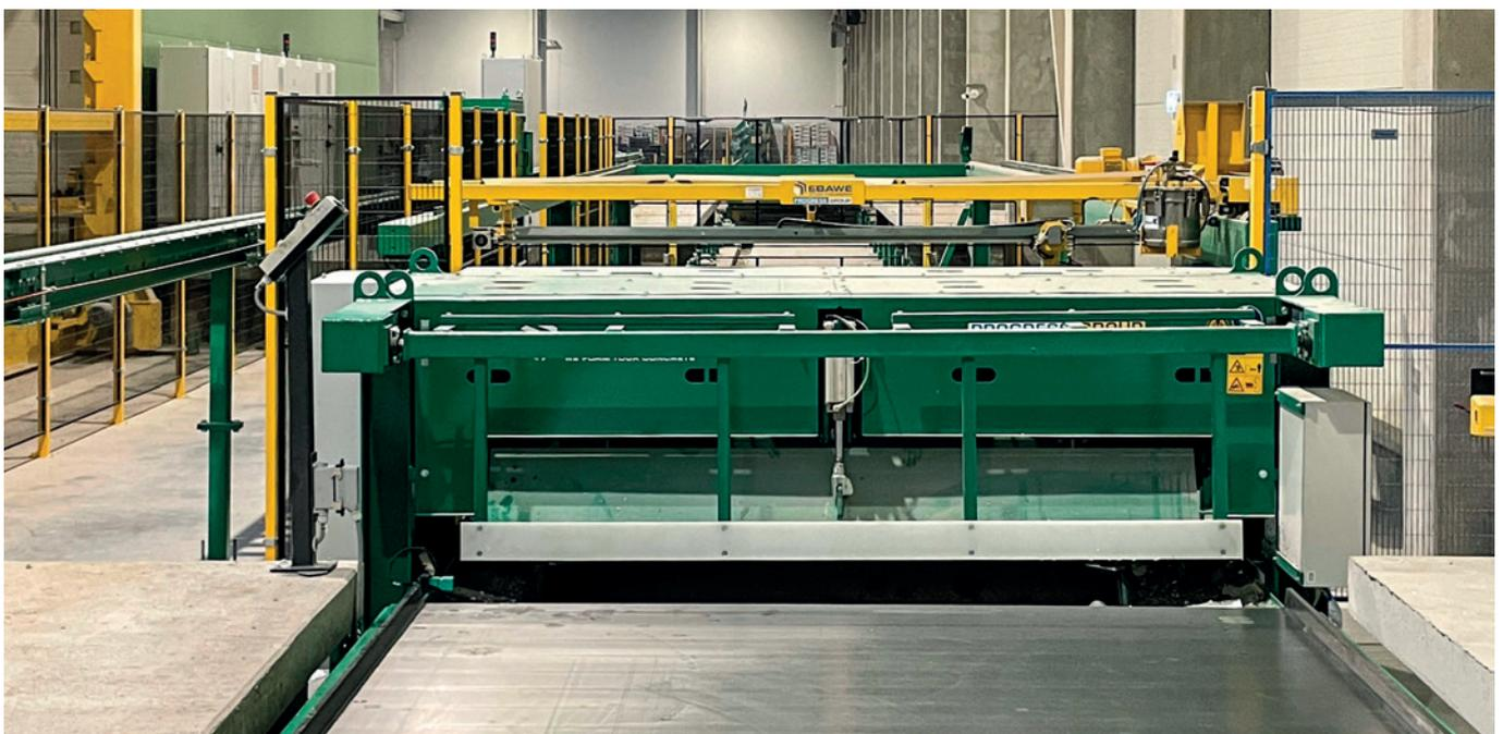
Vor der Rückführung in das System werden die Paletten automatisch gereinigt.
