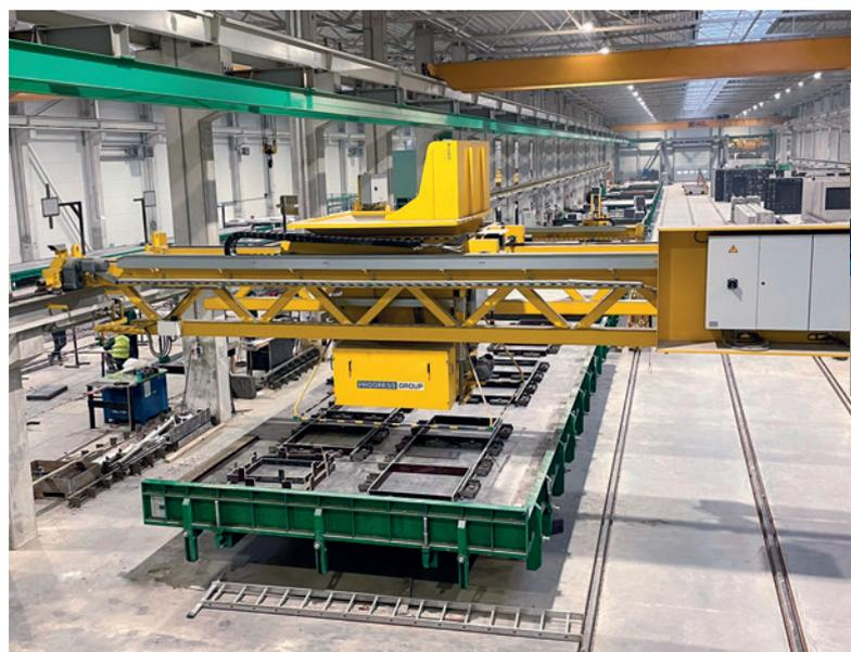
Das über die Paletten laufende Betonverteilersystem arbeitet vollautomatisiert und mit genauen Daten, was zur Einsparung von Beton und Zeit führt.
