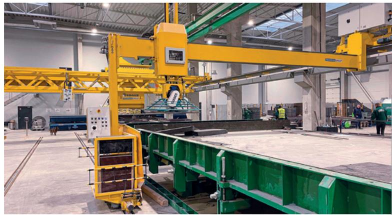
Nach dem Aushärten werden die Betonoberflächen mit einem Flügelglätter abgezogen.
