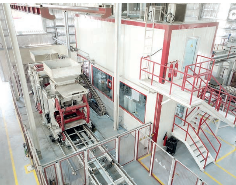
Le cœur de la nouvelle ligne de production est la machine de production de blocs Multimat RH 1500-4.
