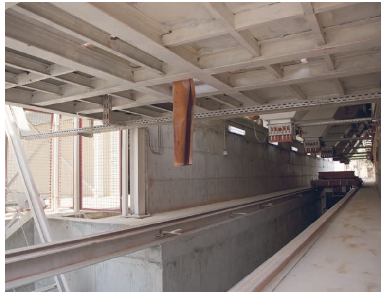
Les granulats sont dosés directement depuis les huit silos disposés en ligne. Des élévateurs à benne alimentent les malaxeurs.
