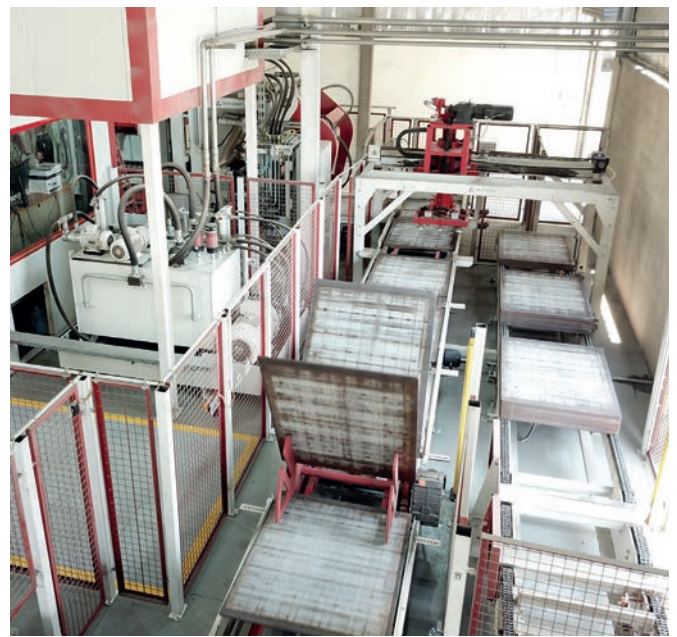
Convoyeur transversal avec dispositif de retournement pour planches (l) et voie tampon ; à l'arrière-plan, l'empileur magnétique
