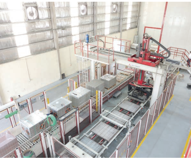
Les paquets de produits sont formés sur le convoyeur à barreaux de 28 m de long disposé en parallèle, puis transportés en cadence vers l'extérieur.
