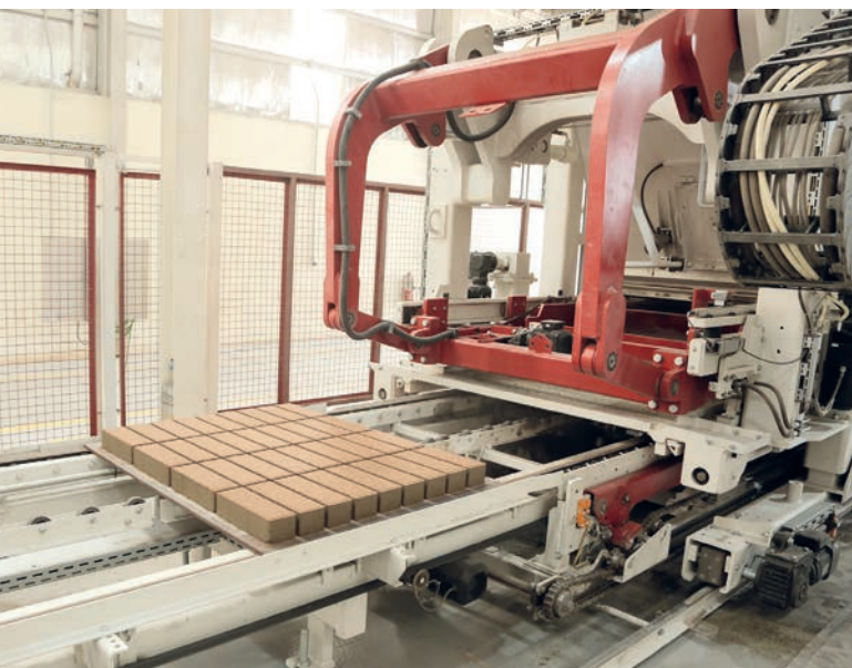
La nouvelle ligne permet de produire des planches d'acier de 1 400 x 1 100 x 14 mm.
