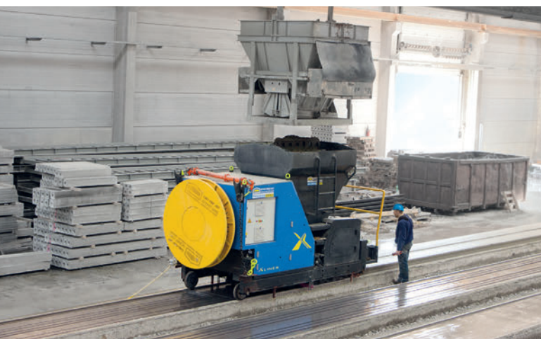
Der hochautomatisierte Extruder X-Liner FC mit „Haifischschnecken“ garantiert eine ausgezeichnete Verdichtung.
