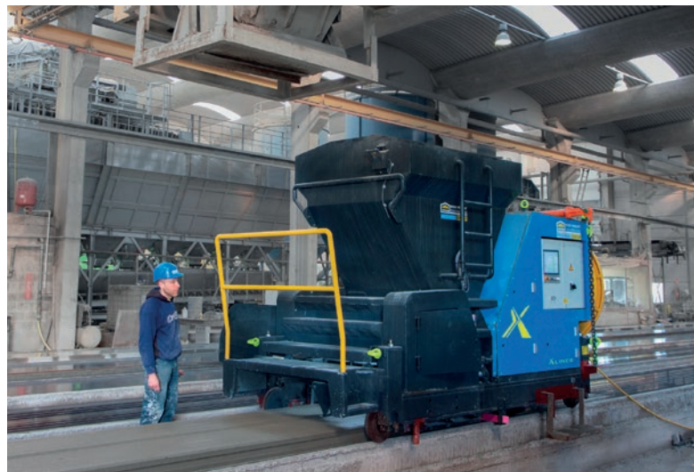
Der Extruder X-Liner benötigt lediglich einen Mitarbeiter für die Betonbeschickung.
