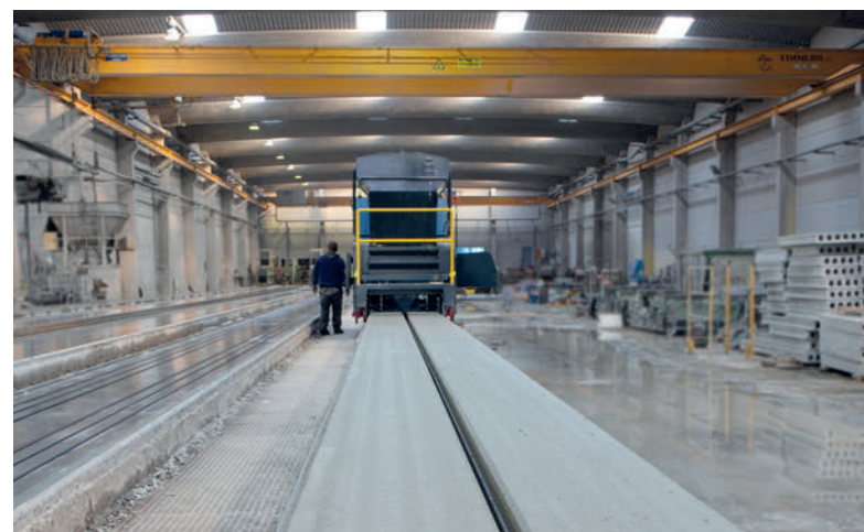
Produktionsbahn von 1,2 m, auf der zwei Spannbetonfertigdecken von 60 cm Breite mit dem Extruder X-Liner gleichzeitig produziert werden.
