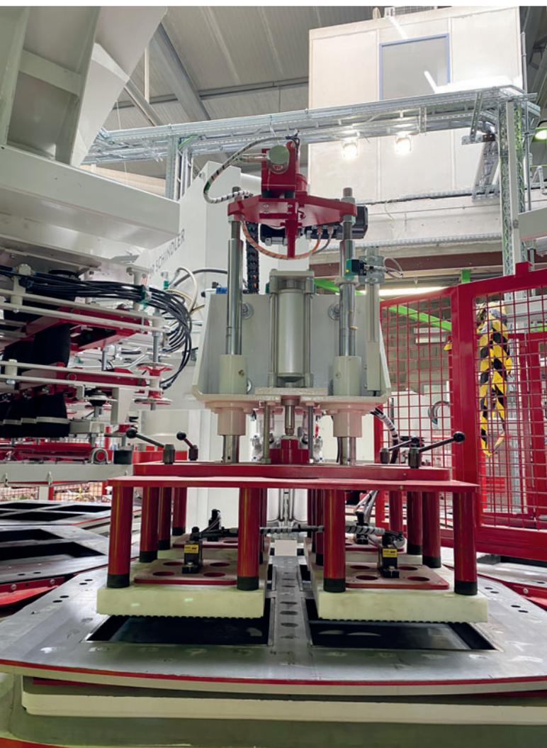
Fig. 4: Dosatore a tubi a sinistra nella foto e distributore di calcestruzzo di rivestimento in primo piano
