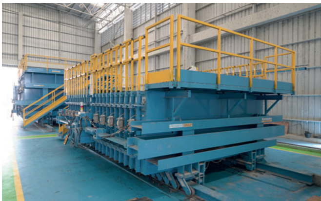
Mit den neuen Batterieschalungen produziert Sansiri Trennwände und Zaunwände.
