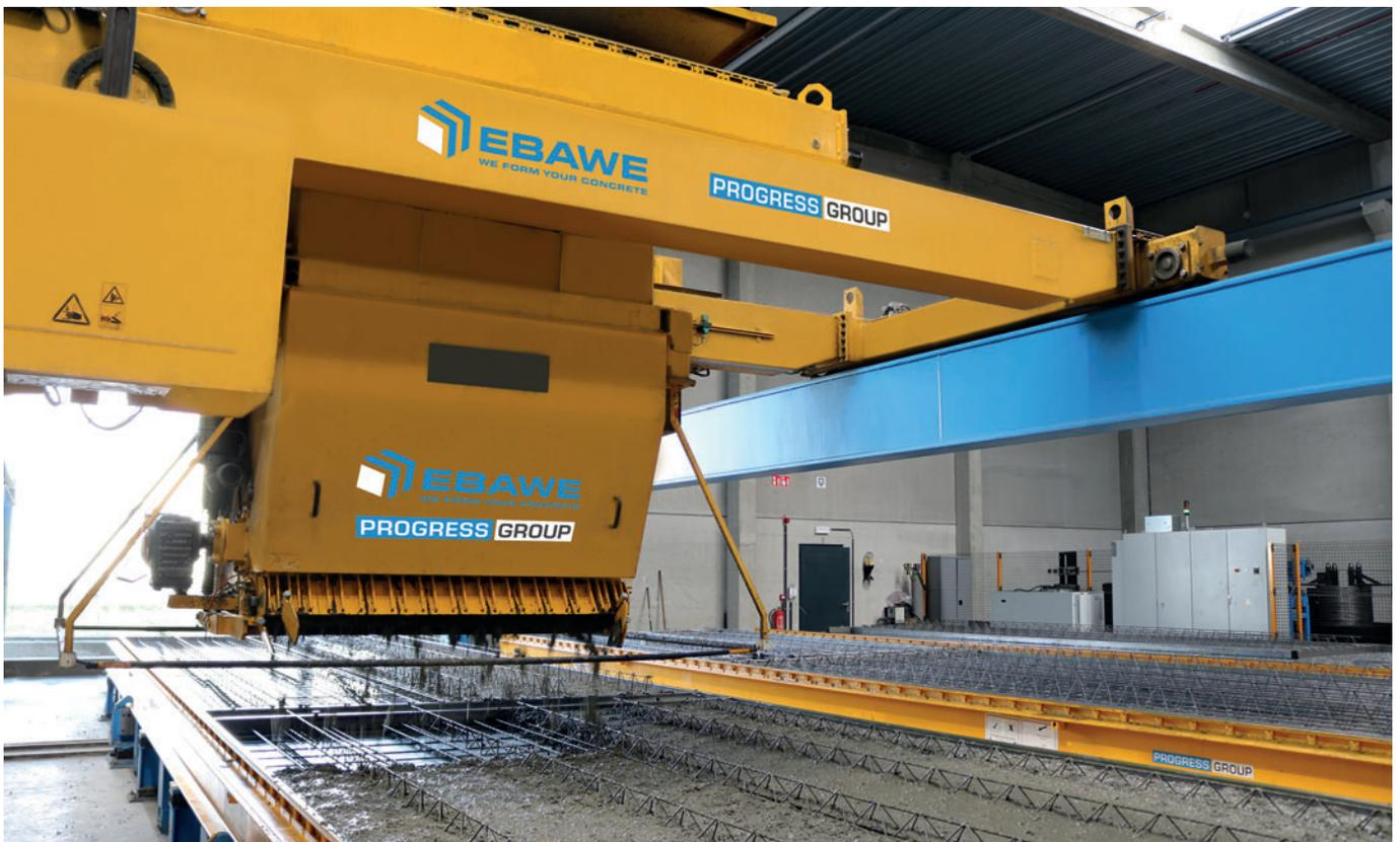
Der automatische Betonverteiler stellt eine gleichmäßige und optimierte Verteilung des Betons in die Schalungen sicher.
