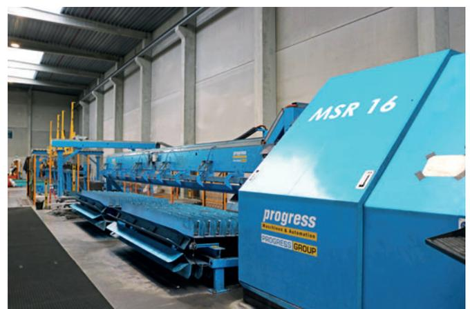
Die Progress MSR 16 Richtschneide-Biegemaschine arbeitet direkt vom Coil und optimiert den Produktionsfluss. Geringe Lagerkosten und einfacheres Materialhandling stellen eine kosteneffektive Produktion sicher.
