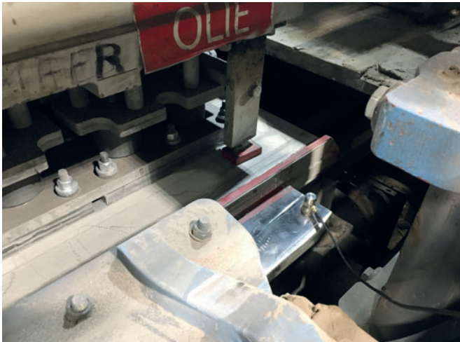
Figura 3: Misurazione delle vibrazioni sullo stampo per blocchi in calcestruzzo
