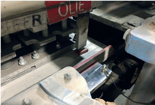
Figura 3: Medición de vibraciones en el molde para bloques de hormigón
