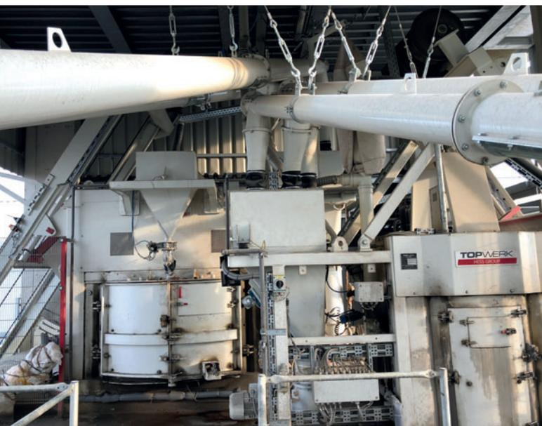
Per produrre il calcestruzzo, si è provveduto ad incorporare un miscelatore del calcestruzzo Hess SM 2250 per il calcestruzzo per lo strato interno e un miscelatore del calcestruzzo Hess SM 400 per il calcestruzzo di rivestimento.
