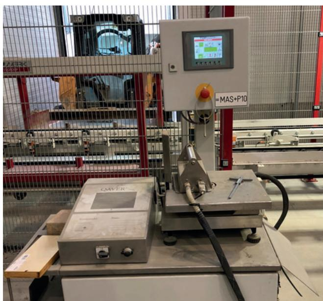
Un apparecchio di prova del calcestruzzo di Qavertec consente di accertare direttamente la qualità dei prodotti realizzati.
