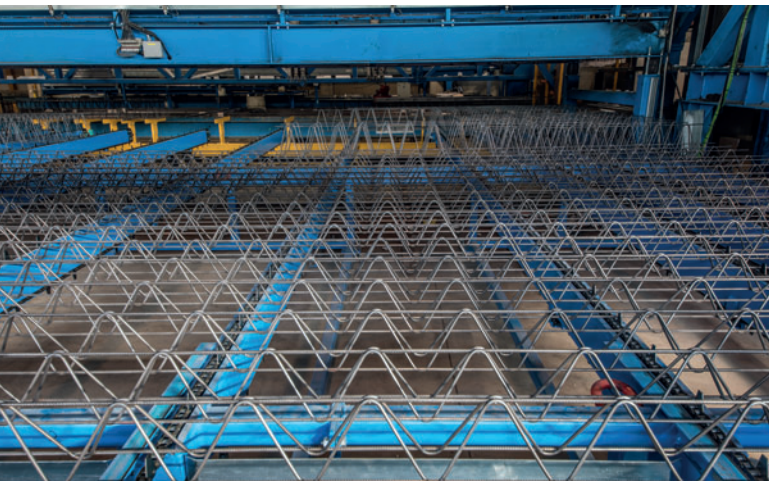
Sowohl die Höhe des Gitterträgers als auch der Drahtdurchmesser können während der Produktion stufenlos verstellt werden.
