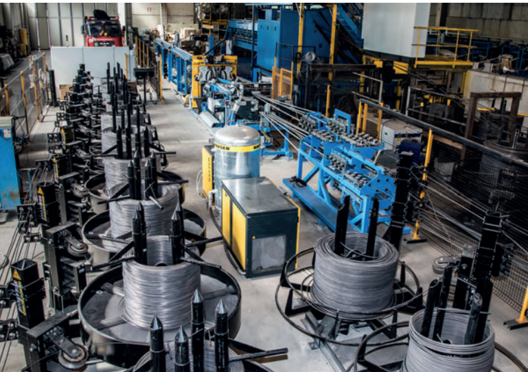
Die neue VGA Versa produziert sämtliche für die Doppelwand- und Elementdeckenproduktion benötigten Gitterträger in-house mit einer Höhe von bis zu 650 mm.
