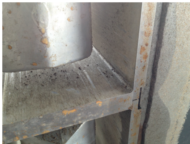
Figura 4: Usura minima negli angoli nello stampo per blocchi Kobra a durezza carbo.
