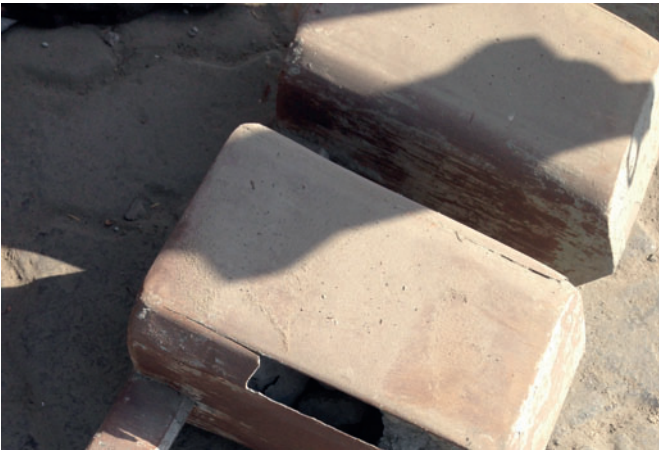
Figura 5: Scatola nitrurata, usura completa
