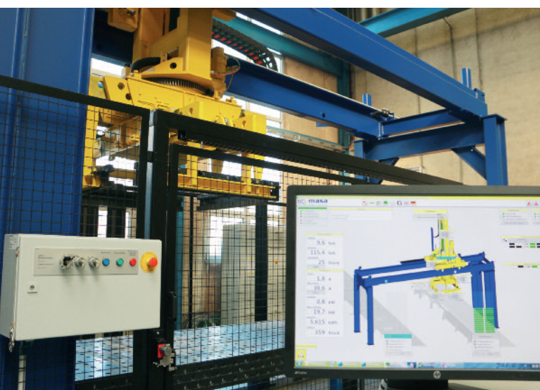
9: W testach osiągnięto cykl produkcyjny wynoszący 9,6 sekund.
