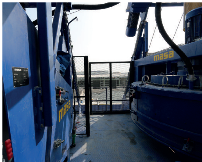
Nowy zakład jest wyposażony w dwie mieszarki Masa: PH 2000/3000 (z prawej) i S 350/500 (z lewej).
