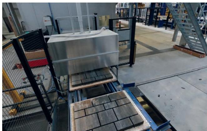
На мокрой стороне производства расположена станция для опционального распыления защитного покрытия на поверхность бетонных изделий
