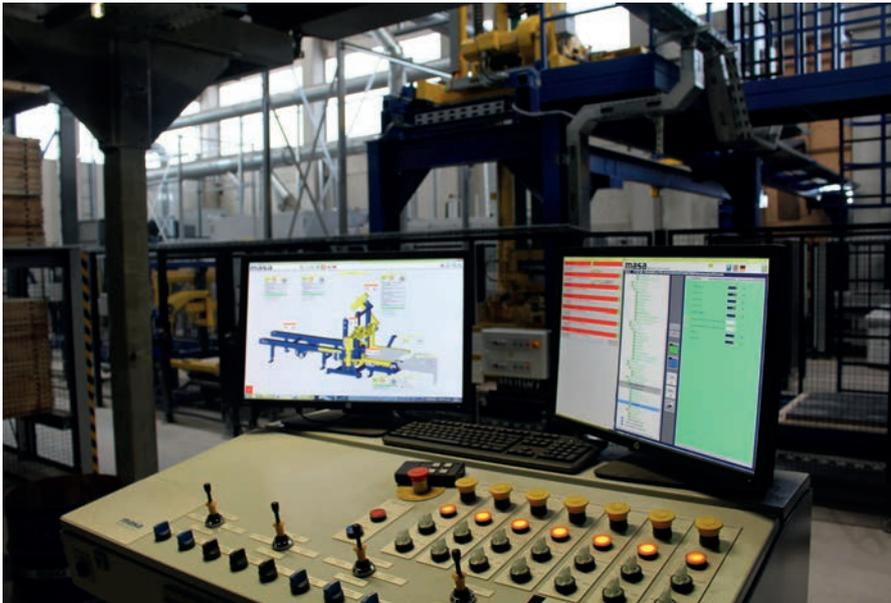
Мониторы с трехмерной визуализацией позволяют контролировать все рабочие процессы без исключения
