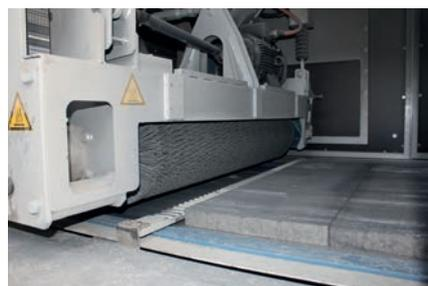
Сдвоенная установка КВН для шлифования щетками
