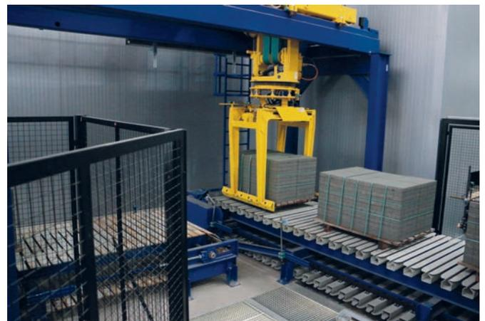
Второй укладчик Masa забирает обвязанные пакеты с блоками и устанавливает их на транспортер, смонтированный под углом 90°
