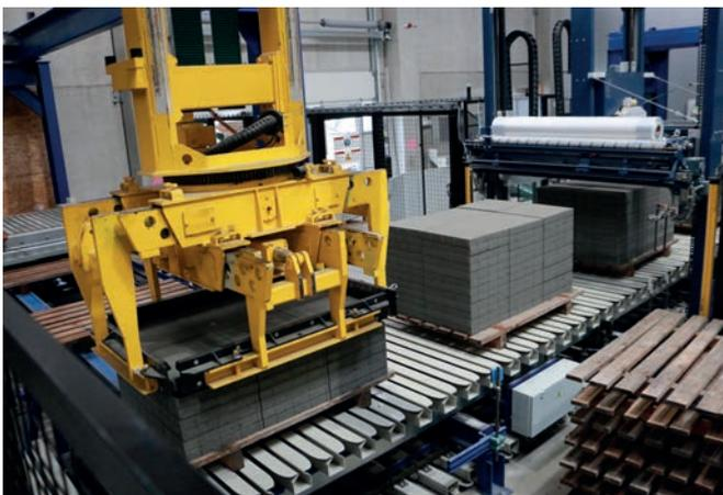
Masa Cuboter: станция пакетирования с сервоприводами забирает слои блоков из различного положения и формирует из них пакеты на транспортировочных паллетах
