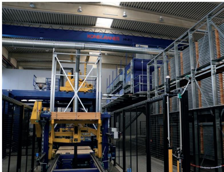
Цепной транспортер для технологических поддонов
