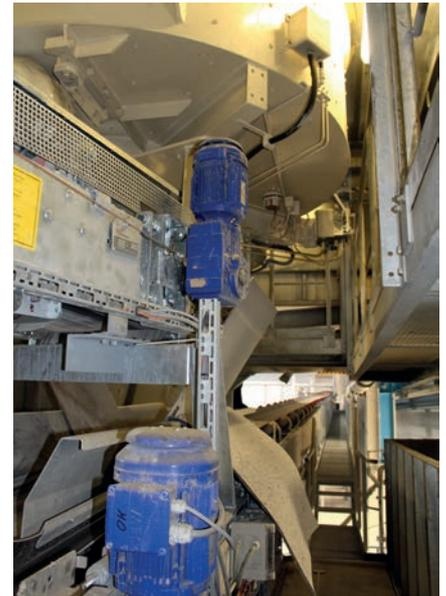
Смеситель Liebherr RH 0.5 для производства облицовочной бетонной смеси с выгрузкой на ленточный транспортер
