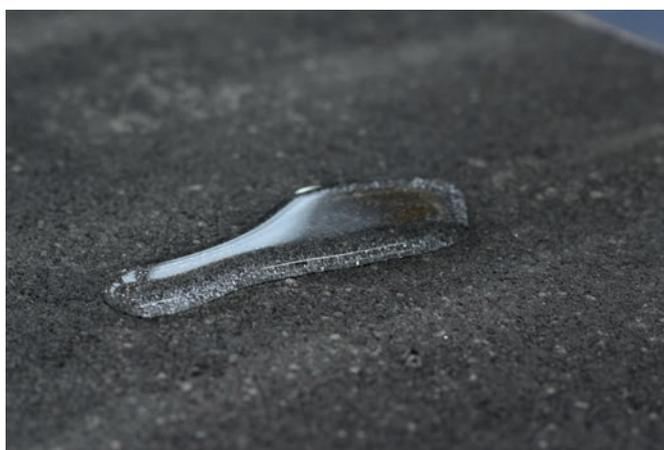
Поверхность изделий, выпускаемых на установке Masa, отличается структурой высокой плотности
