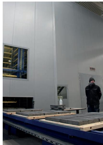
Опускной штабелер передает поддоны по одному на балочный транспортер на сухой стороне производства
