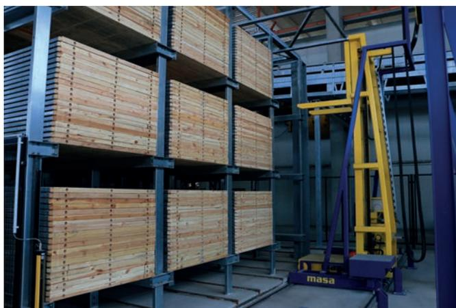
Транспортировочная тележка забирает готовые пакеты с изделиями и возвращает их на бетоноформовочную машину либо направляет штабель в стеллажный накопитель
