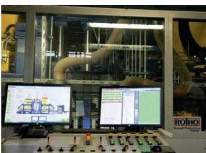
Рядом с бетоноформовочной машиной установлен пульт управления. Большая прозрачная панель позволяет следить за работой узлов машины
