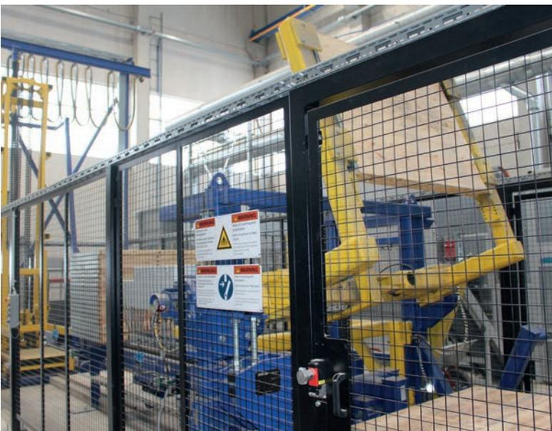
Кантователь Masa с Z-образной схемой
