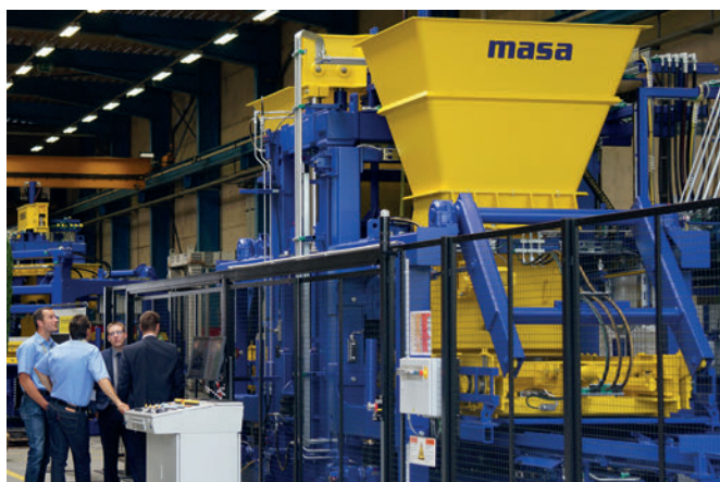
Особый интерес вызвала демонстрация рабочих установок: камнеформовочной линии Masa XL 9.2 и...
