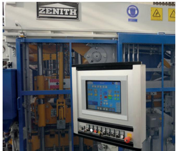
Control totalmente automático de la máquina superpuesta Zenith 844 SC
