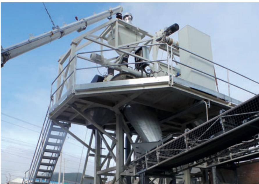
Mezcladora y transportador de cinta Euromecc para alimentar la máquina superpuesta
