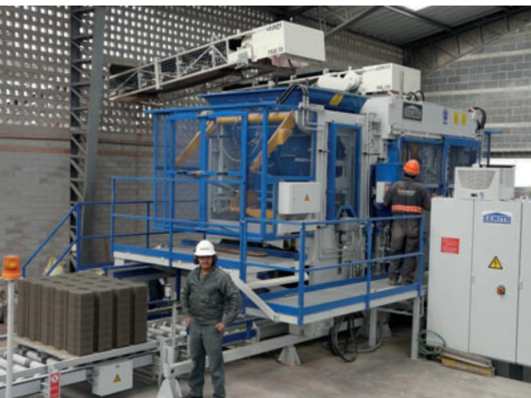
Máquina superpuesta Zenith 844 SC para adoquines con hormigón bicapa
