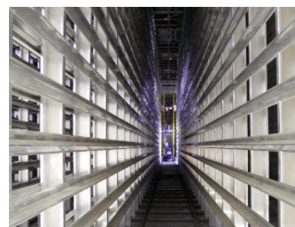
W sumie system regałowy mierzy 26 300 x 21 280 mm i ma wysokość całkowitą 9 500 mm.
