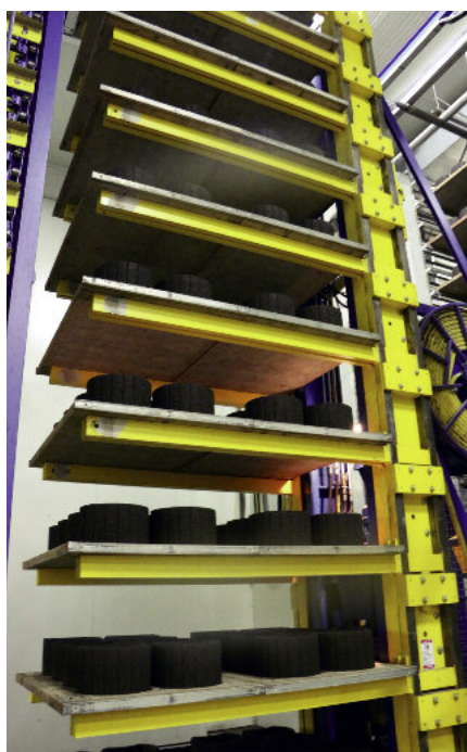
Odstęp między ramionami wózka jest dopasowywany do wysokości wyrobów.
