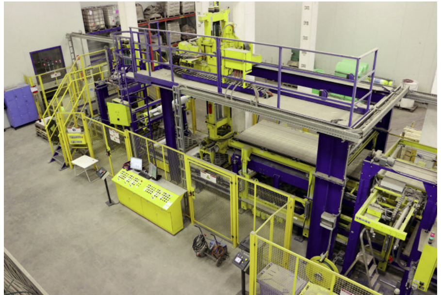
Linia sucha ze stanowiskiem sortującym dla kostki brukowej, elementów ogrodowych i krawężników o optymalnej prędkości sortowania.
