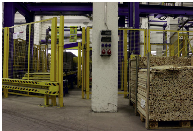
Bezpieczna praca bez straty czasu – dzięki fotokomórkom można rozmieszczać listwy nie zakłócając procesu produkcji.
