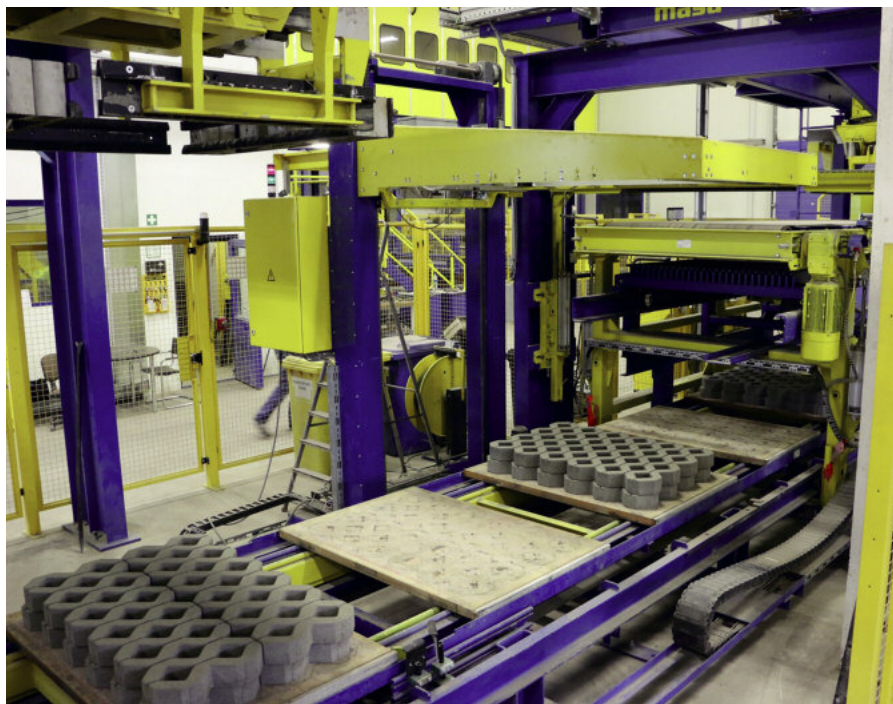
Urządzenie do owijania w płaszczyźnie poziomej – poszczególne warstwy wyrobów są owijane zarówno podczas odtransportowywania jak i po sortowaniu.
