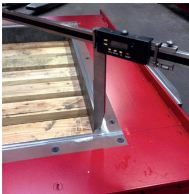
*Controllo dello scostamento dimensionale nel controllo finale della
