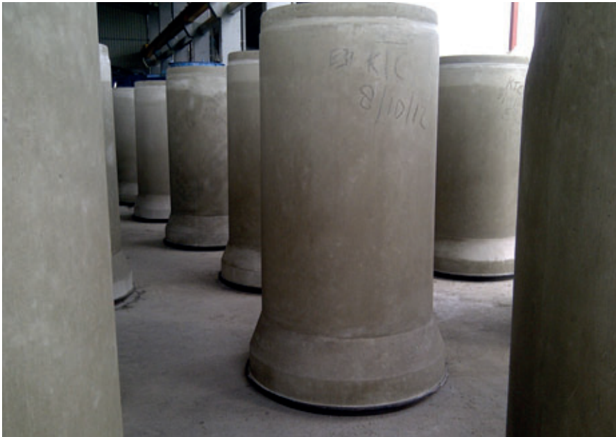
Tuyaux en béton dans l'espace de durcissement
