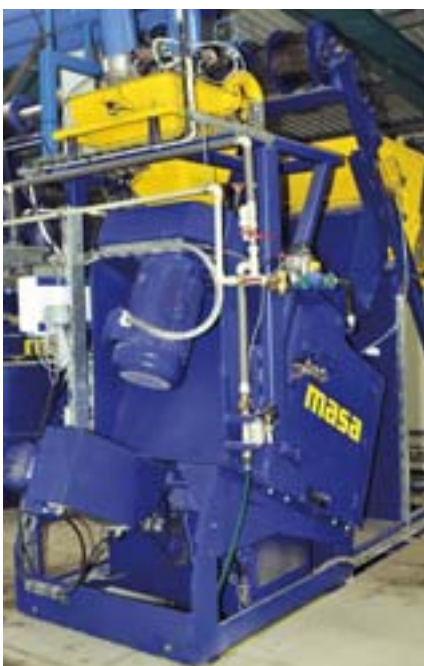
Betoniarka do produkcji mieszanki licowej, model Twister S 350/500.
