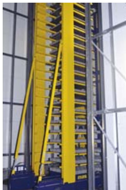
Winda wstępna jako przesuwny bufor między wózkiem widłowym a windą rozpiętrowującą.
