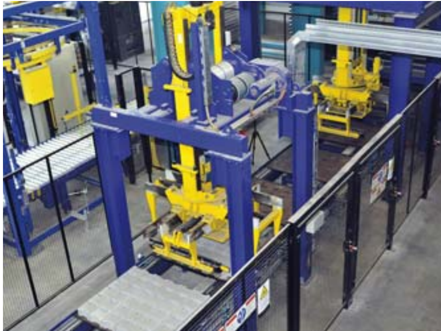
Obieg powrotny z centrownikiem i pakieciarką.
