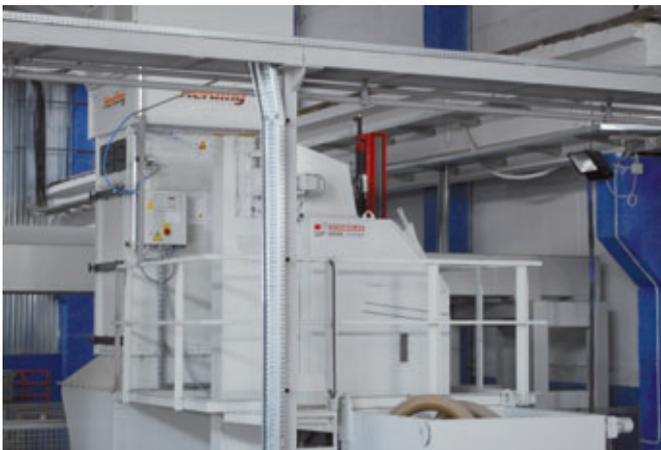
*Sabbiatrice con filtri lamellari sinterizzati*
