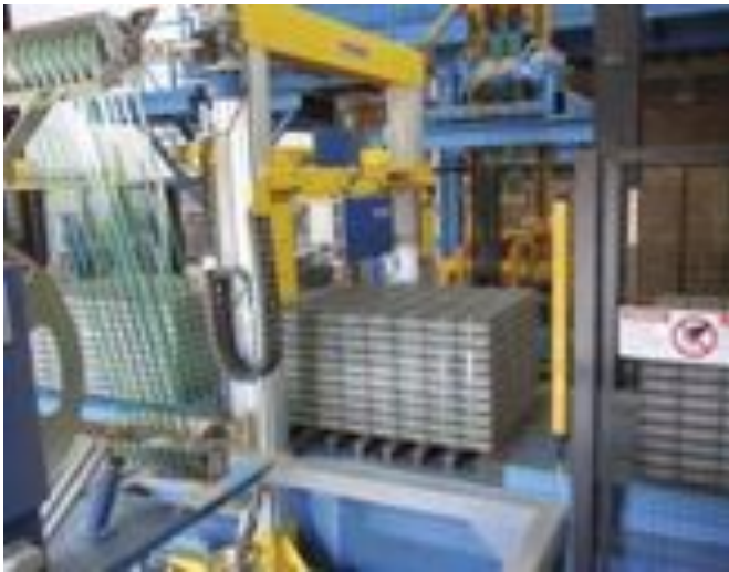
Przeñośnik skokowy paczek wyrobów ze stanowiskiem owijania w pionie bez palet handlowych.
