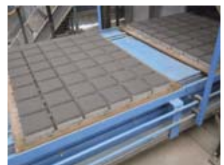
Kostka brukowa na linii suchej.
