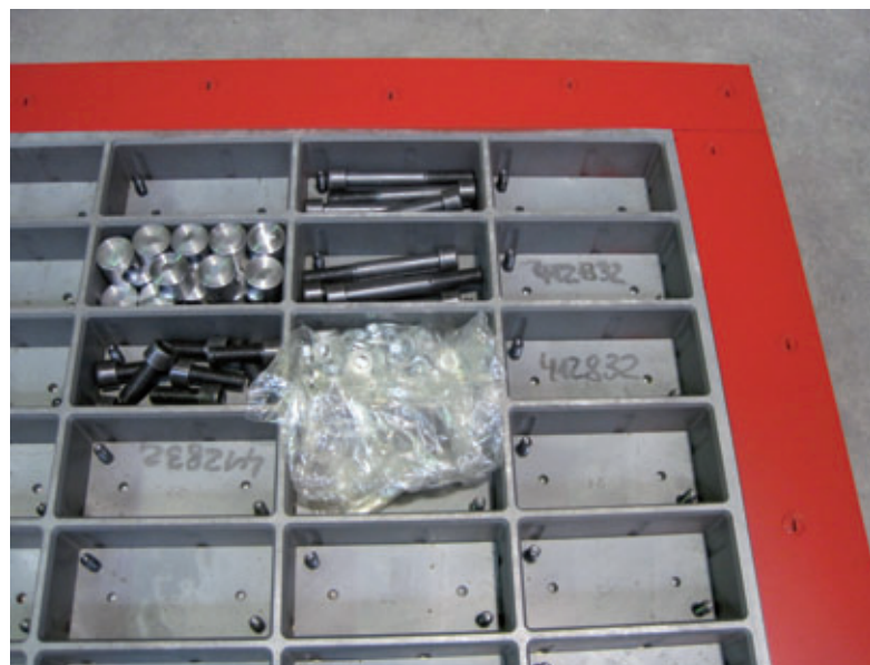
Fig. 2: Parte inferiore dello stampo »Moduline2« con pestelli fornite sciolte e set di fissaggio per le flangie a vite
