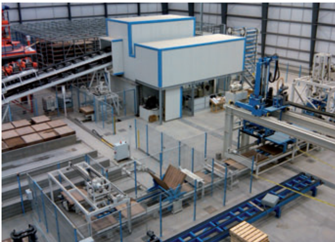
Illustration 1 : L'automatisation du site Sims Stone a permis d'optimiser la conception des côtés humide et sec avec à la clé d'excellents résultats en termes de qualité, de rendement et de coût à l'unité.
