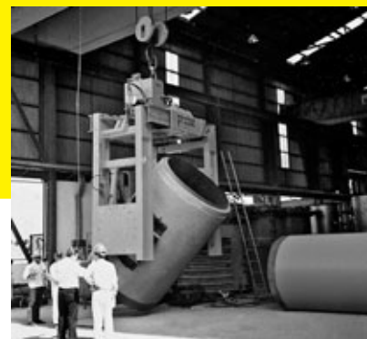
Grappin de retournement pour portique PWG-R le complément idéal à tout pont roulant.
