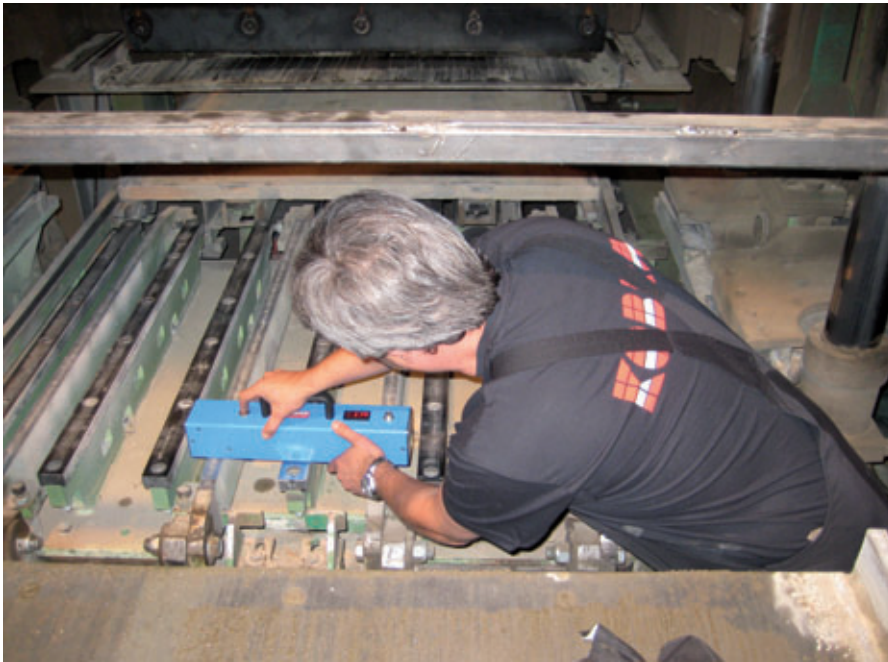
Misurazione delle luci delle spranghe di una tavola vibrante
