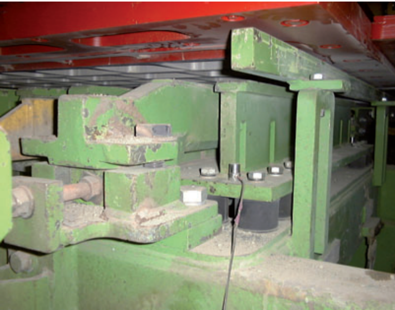
Posizione del sensore di oscillazione durante la misurazione a 5 punti
