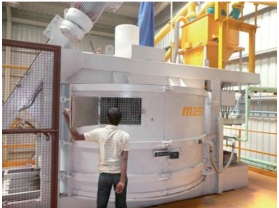
Dwie mieszarki do betonu firmy Masa produkują beton licowy i konstrukcyjny dla wyrobów betonowych.
