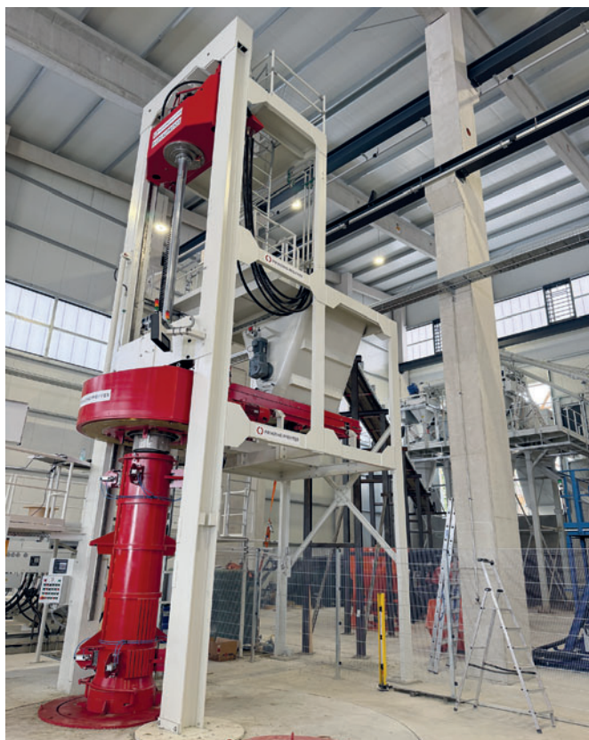
Радиальный пресс RP компании Prinzing Pfeiffer – высокопроизводительная машина для производства бетонных, железобетонных и напорных труб различных размеров, и первые железобетонные трубы, произведенные в Нистерау
