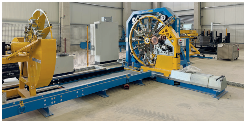
Сварочная машина Progress серии VTA для изготовления арматурных каркасов
