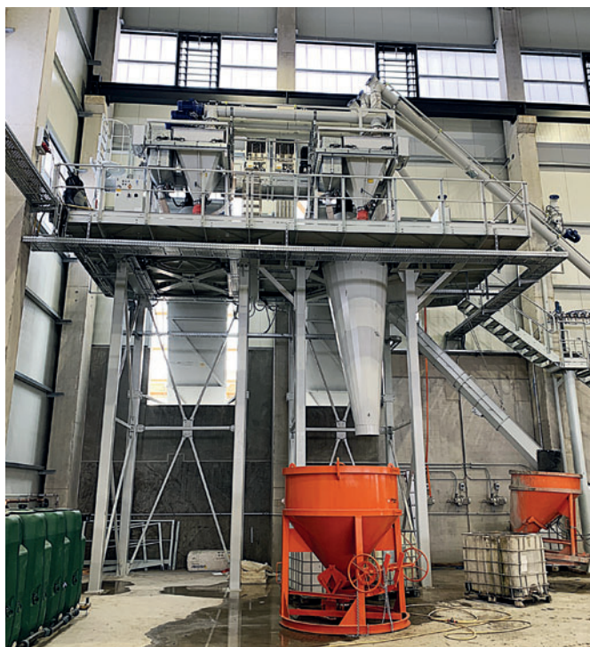
Двойная БСУ Wiggert была поставлена в заводских предварительно собранных модулях, что позволило провести быстрый и простой монтаж
