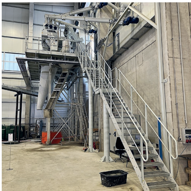
Podwójny węzeł betoniarski firmy Wiggert został dostarczony w postaci prefabrykowanych modułów, co umożliwiło szybki i łatwy montaż.
