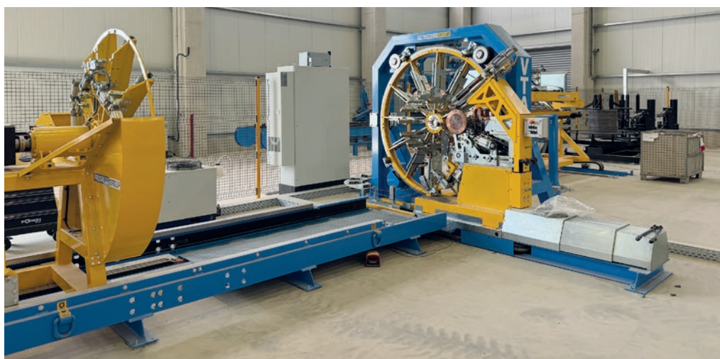
Zgrzewarka do koszy zbrojeniowych Progress z serii VTA przeznaczona do produkcji koszy zbrojeniowych.
