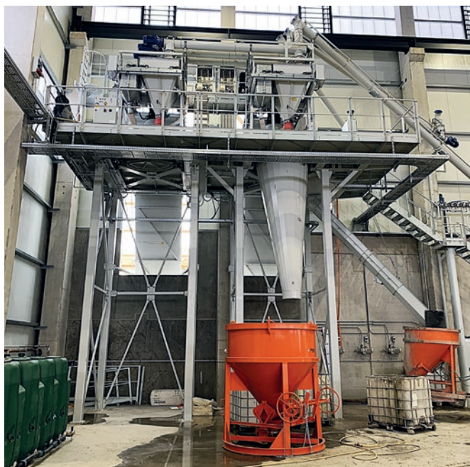
Podwójny węzeł betoniarski firmy Wiggert został dostarczony w postaci prefabrykowanych modułów, co umożliwiło szybki i łatwy montaż.
