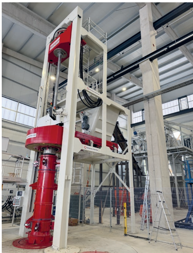
Prasa radialna RP firmy Prinzing Pfeiffer – wysokowydajna maszyna do produkcji rur betonowych, żelbetowych oraz rur ciśnieniowych w różnych rozmiarach – oraz pierwsze rury żelbetowe wyprodukowane w Nisterau.
