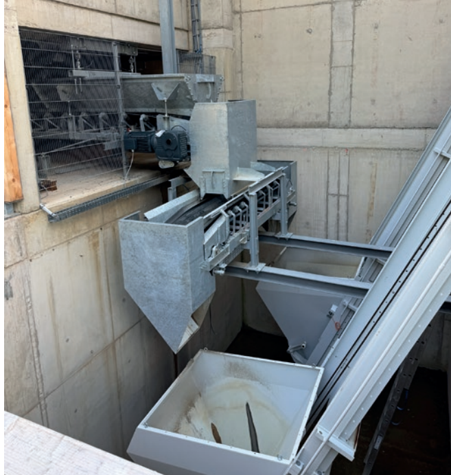
W zależności od kierunku pracy przenośnik rozdzielający napęlnia jeden z dwóch wyciągów skipowych.
