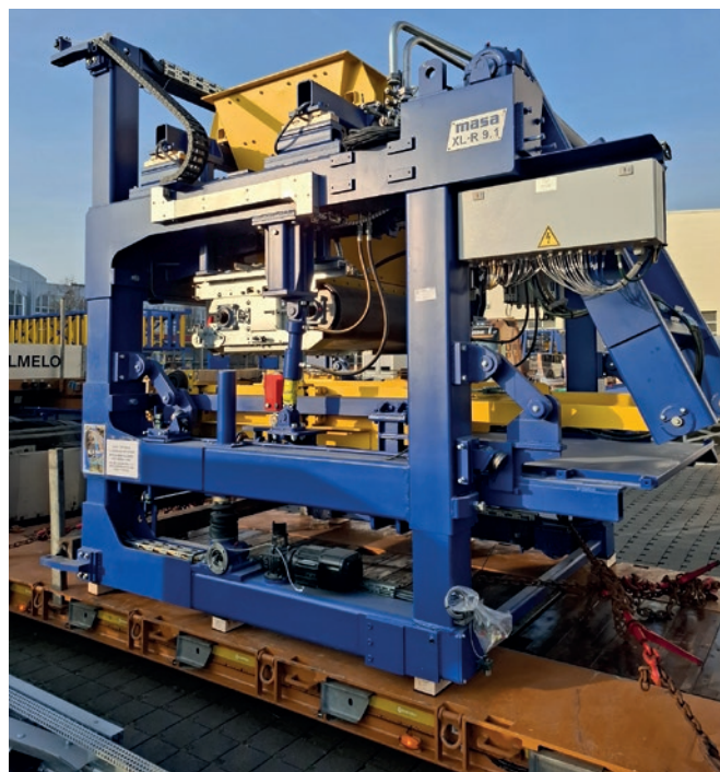
Przygotowany do transportu do Algierii: zasyp mieszanki licowej wibroprasy XL R 9.1.
