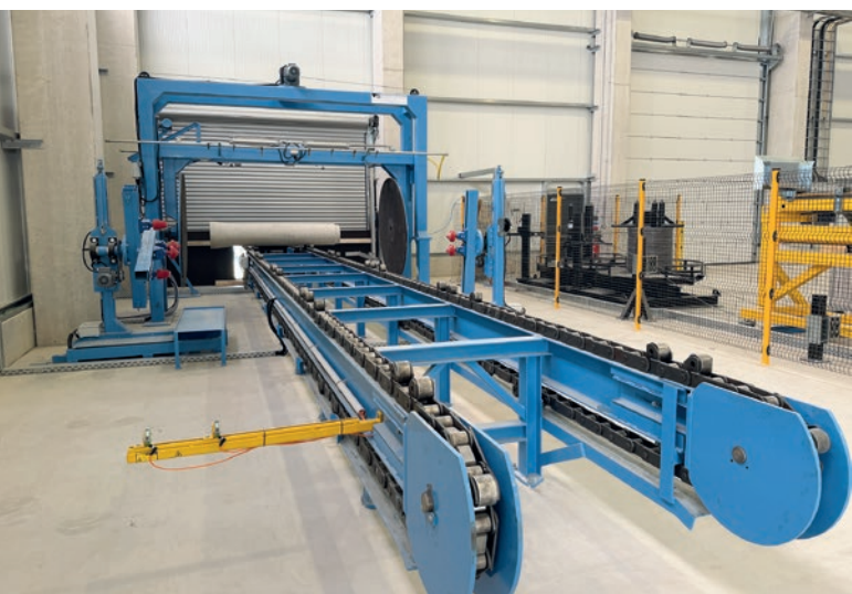
La linea di collaudo per tubi di Messmann serve al controllo qualità.
