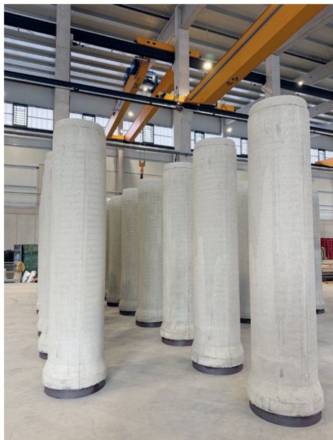
Pressa radiale RP di Prinzing Pfeiffer, una macchina ad alte prestazioni per la produzione di tubi in calcestruzzo, tubi in calcestruzzo armato e tubi a pressione di varie dimensioni, e i primi tubi in calcestruzzo armato prodotti a Nisterau.
