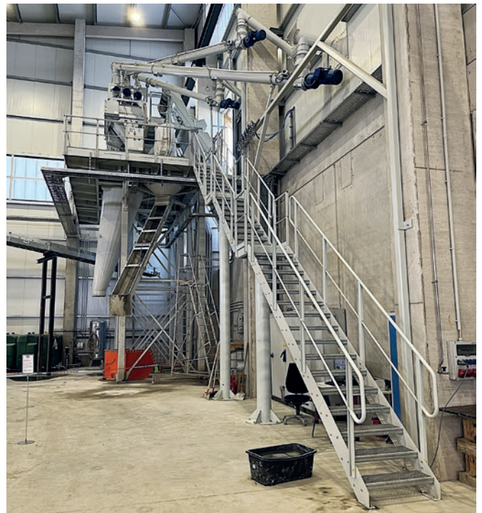
L'impianto di miscelazione doppio di Wiggert è stato fornito in moduli prefabbricati in fabbrica, consentendo così un montaggio rapido e semplice.
