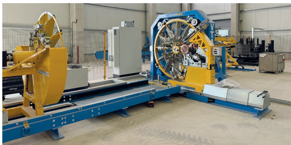
Gabbiatrice Progress della serie VTA per la produzione delle gabbie di armatura.
