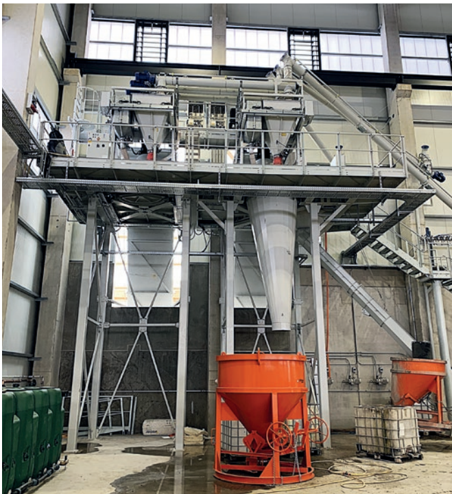
L'impianto di miscelazione doppio di Wiggert è stato fornito in moduli prefabbricati in fabbrica, consentendo così un montaggio rapido e semplice.
