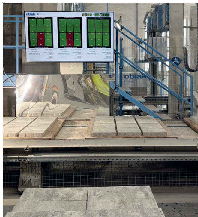
Controllo qualità in linea sul lato asciutto
