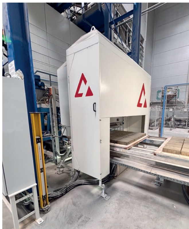
Controllo qualità in linea sul lato umido
