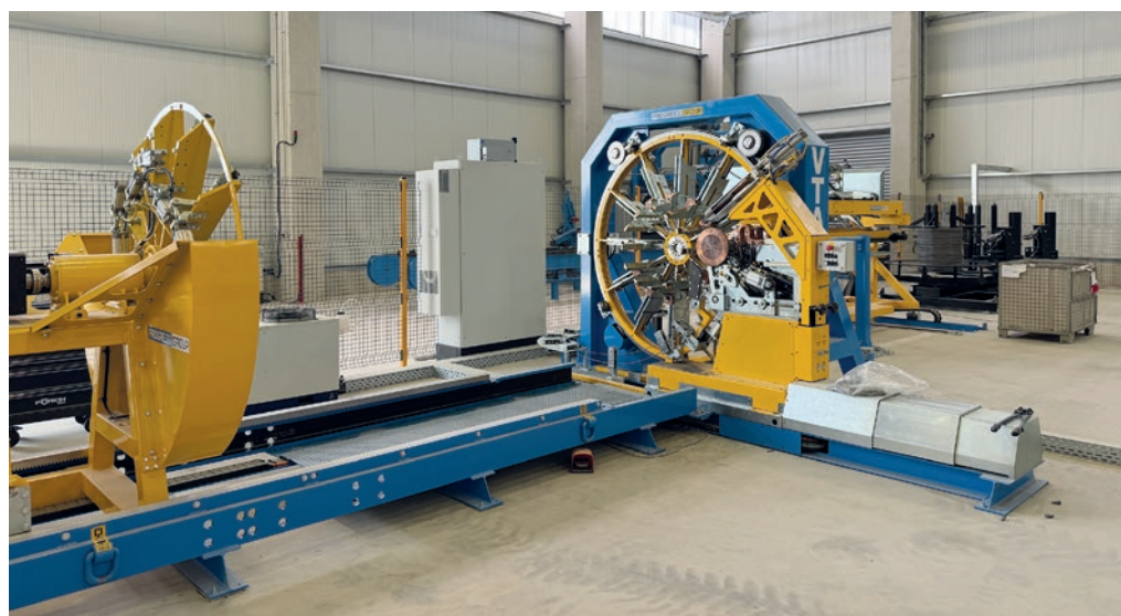
Cageuse automatique Progress de la série VTA pour la fabrication des cages d'armature.
