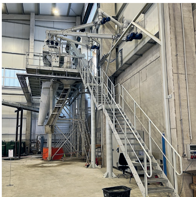
La centrale de malaxage double de Wiggert a été livrée en modules préfabriqués en usine, ce qui a permis un montage rapide et simple.
