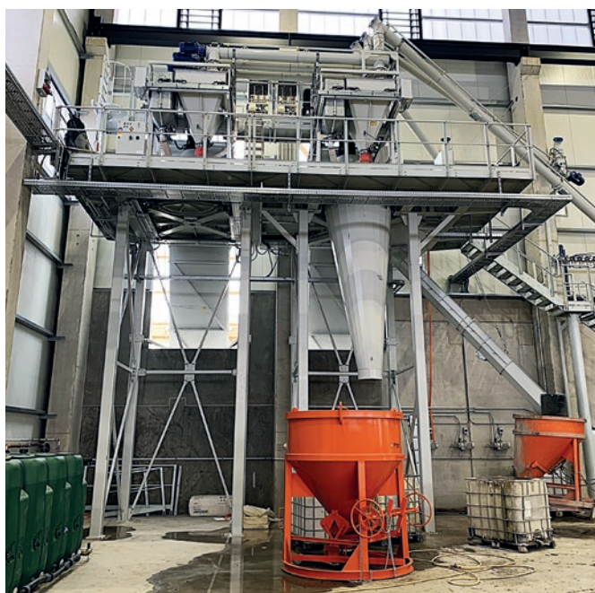
La centrale de malaxage double de Wiggert a été livrée en modules préfabriqués en usine, ce qui a permis un montage rapide et simple.
