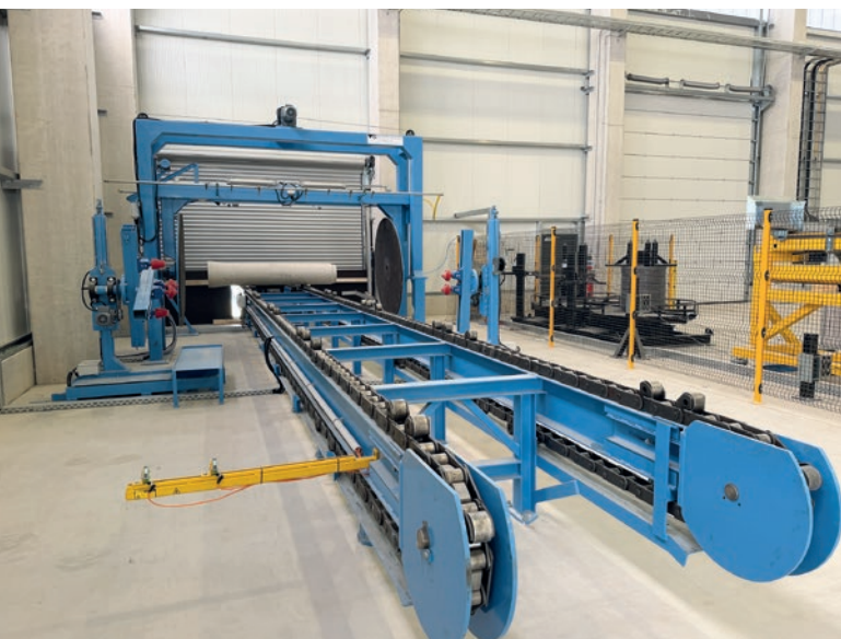
La ligne de contrôle des tuyaux de Messmann sert au contrôle de qualité.
