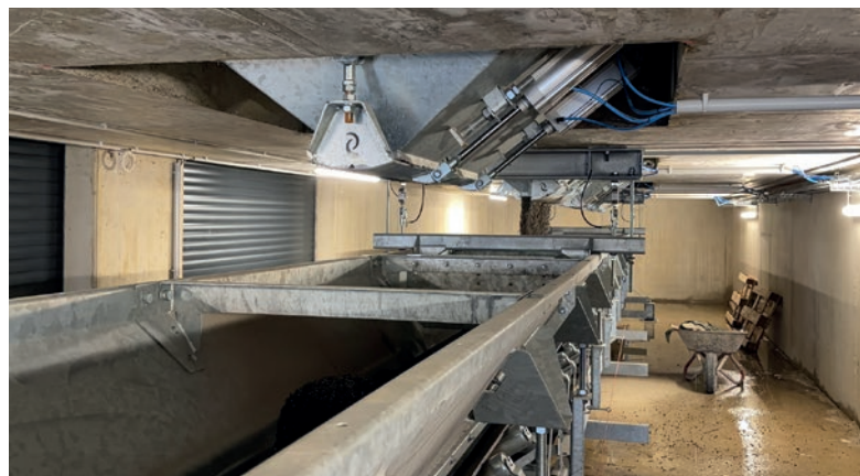
Le dosage des granulats s'effectue au moyen de doubles vannes de dosage intégrées dans le fond des chambres de silo.
