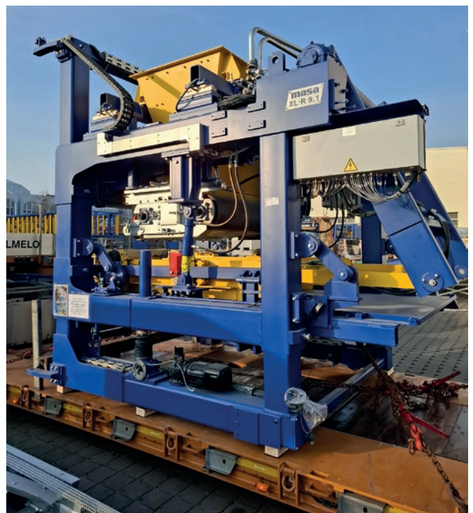
Préparation pour le transport vers l'Algérie : dispositif de remplissage de béton de parement de la XL-R 9.1
