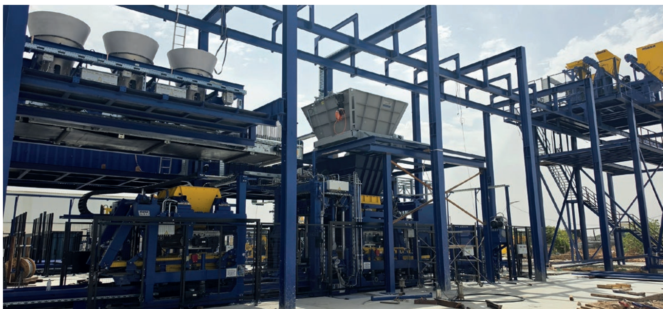
En cours de développement, mais déjà clairement identifiable : la Masa XL-R 9.1, équipée du système Multi-Color, constitue le cœur de la nouvelle ligne de production.
