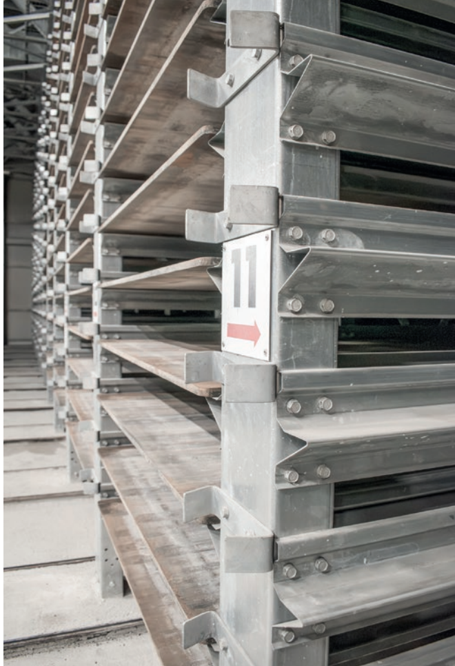
Les montants du rayonnage, les traverses et les supports sont fabriqués en acier revêtu de Magnelis.
