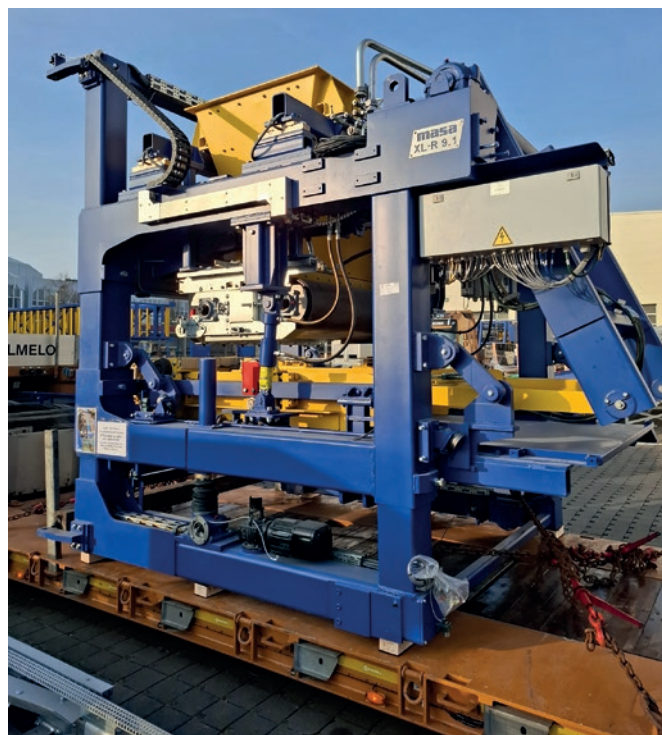
Preparada para su transporte a Argelia: Pieza de relleno para hormigón bicapa XL-R 9.1
