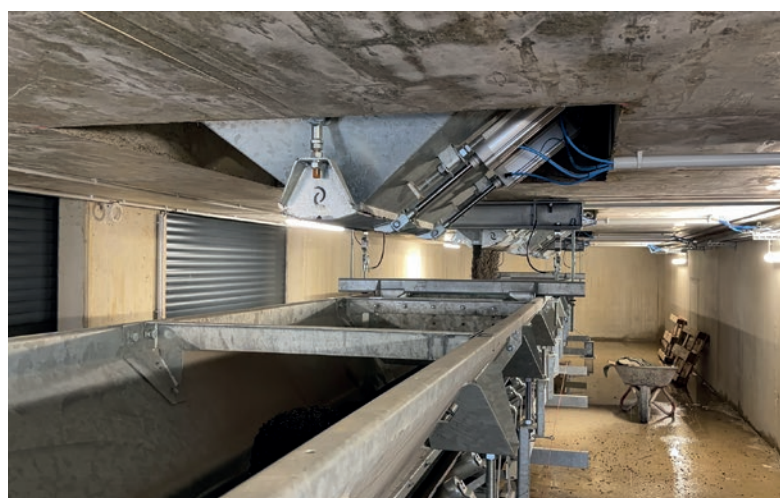
La dosificación de los áridos se realiza mediante dobles compuertas de dosificación integradas en el fondo de las cámaras del silo.
