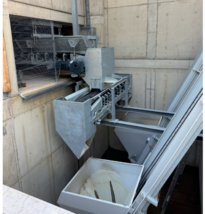
La cinta distribuidora llena, según el sentido de marcha, uno de los dos elevadores de alimentación.
