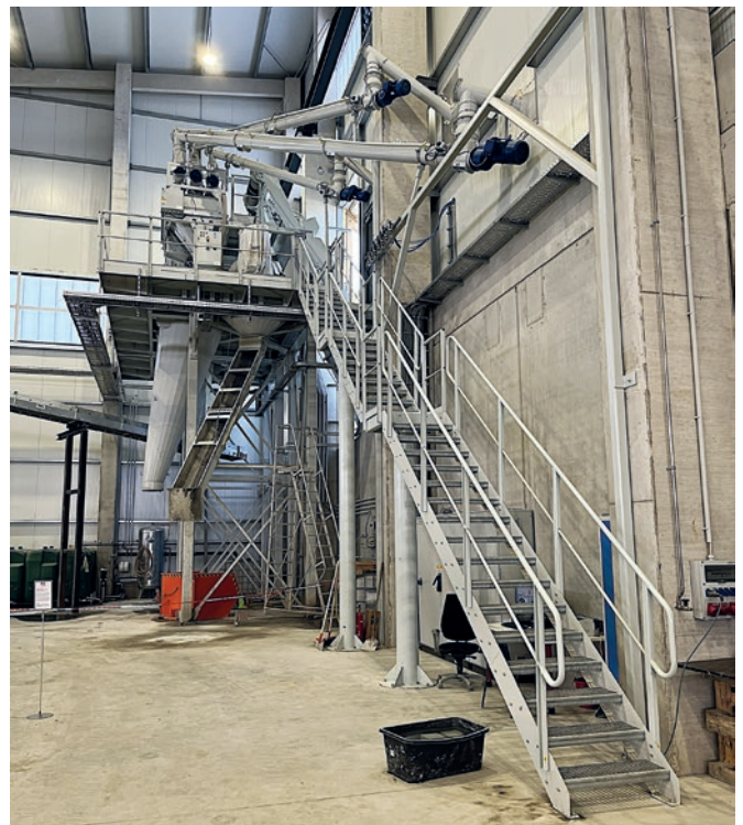
La instalación de doble mezclado de Wiggert se suministró en módulos prefabricados en fábrica, lo que permitió un montaje rápido y sencillo.
