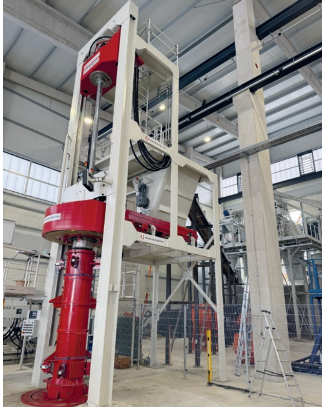
Prensa radial RP de Prinzing Pfeiffer, una máquina de alto rendimiento para la producción de tubos de hormigón, hormigón armado y tubos de presión en diferentes tamaños, y los primeros tubos de hormigón armado producidos en Nisterau.
