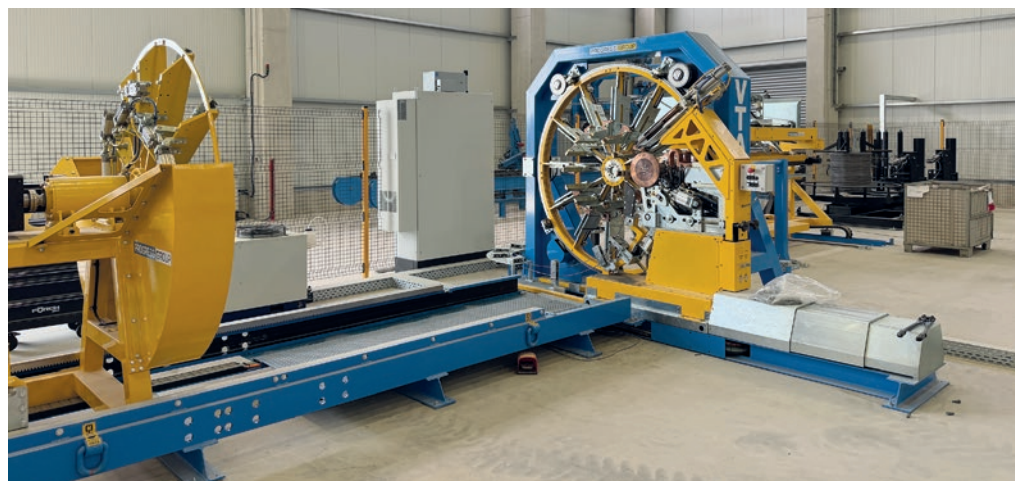
Máquina soldadora de armaduras Progress de la serie VTA para la fabricación de jaulas de armadura.
