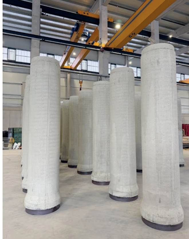
Prensa radial RP de Prinzing Pfeiffer, una máquina de alto rendimiento para la producción de tubos de hormigón, hormigón armado y tubos de presión en diferentes tamaños, y los primeros tubos de hormigón armado producidos en Nisterau.
