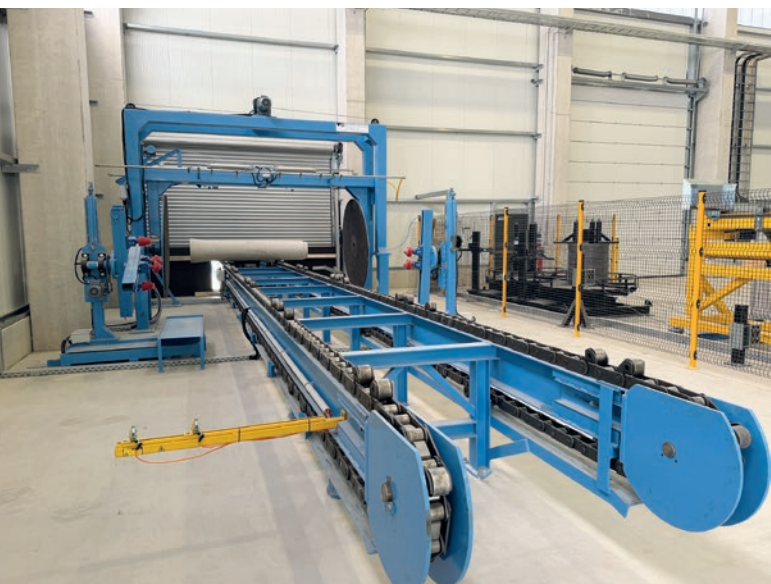
La línea de ensayo de tubos de Messmann sirve para el control de calidad.
