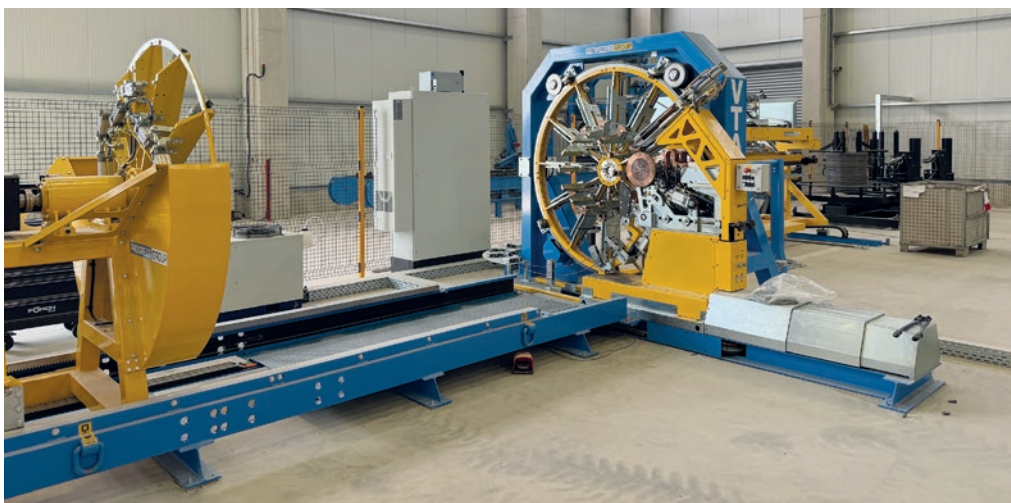
Progress-Korbschweißmaschine der VTA-Serie zur Herstellung der Bewehrungskörbe
