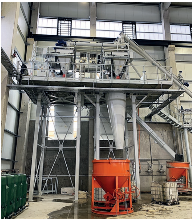
Die Doppelmischanlage von Wiggert wurde in werksseitig vorgefertigten Modulen geliefert, was eine schnelle und einfache Montage ermöglichte.
