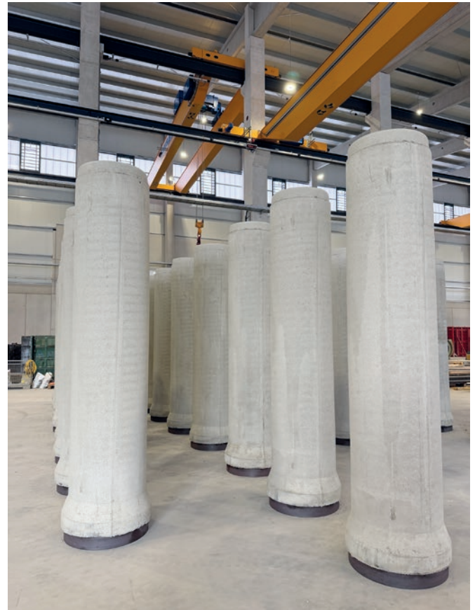
Radialpresse RP von Prinzing Pfeiffer, eine Hochleistungsmaschine für die Produktion von Beton-, Stahlbeton- und Druckrohren in verschiedenen Größen und die ersten in Nisterau produzierten Stahlbetonrohre
