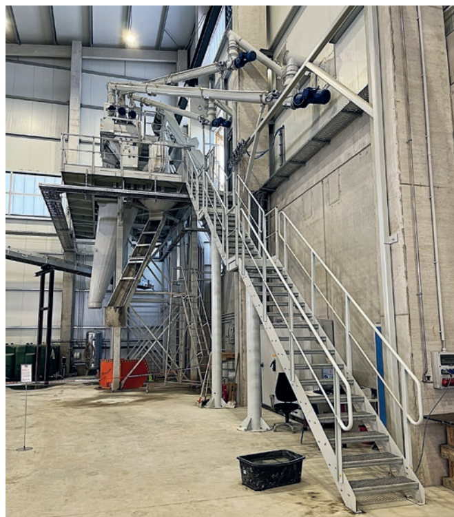
Die Doppelmischanlage von Wiggert wurde in werksseitig vorgefertigten Modulen geliefert, was eine schnelle und einfache Montage ermöglichte.
