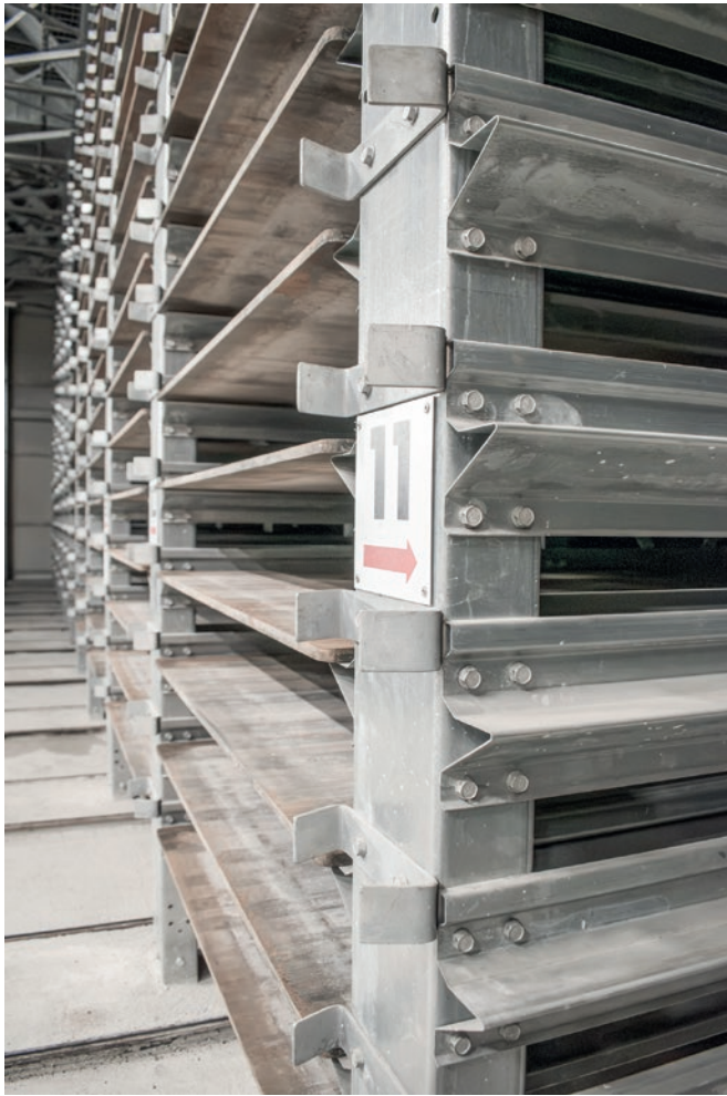
Regalstützen, Querträger und Auflagen werden aus Magnelis-beschichtetem Stahl gefertigt.
